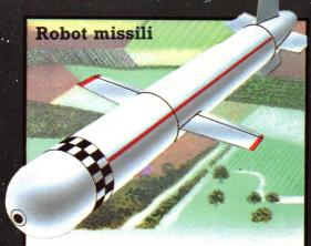
Alcuni tipi di missili vengono considerati dagli esperti come robot. Sono programmati per raggiungere il bersaglio automaticamente, utilizzando sensori e un computer a bordo. I missili Cruise, per esempio, si servono di sensori per "vedere" il terreno sottostante, poi confrontano questi dati con una carta computerizzata del loro percorso; in tal modo possono volare molto bassi ed evitare il rilevamento dei radar.
