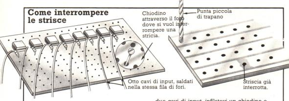
Il circuito finito assomiglierà a questo. Ora si devono interrompere le strisce sulla faccia inferiore del Veroboard che toccano i diversi cavi di input, per impedire che la corrente passi da uno all'altro. Per identificare un foro nella striscia fra due cavi di input, infilatevi un chiodino e capovolgete la tavola di Veroboard.
