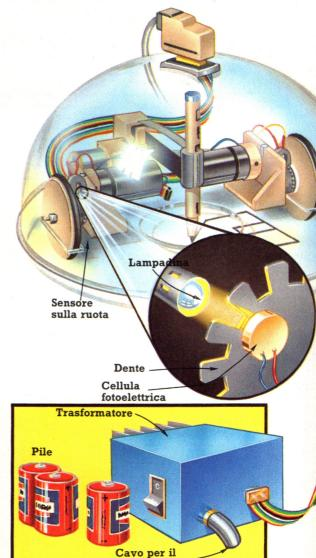
La maggior parte dei microrobot sono azionati da motori elettrici a basso voltaggio, quindi vengono alimentati da un trasformatore o da pile. Di solito l'alimentatore è collegato ad un'interfaccia elettronica.
