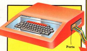
I fili elettrici, chiamati linee di controllo, che controllano appunto i motori del robot, vengono inseriti in una presa del computer, chiamata porta. (Non tutti gli home computer hanno le porte adatte a questa operazione.) Spesso ogni motore è collegato a un filo.
