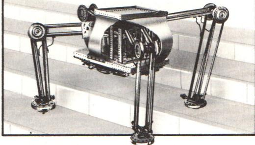
Un robot a quattro gambe che cammina, capace di salire scale, è stato costruito da scienziati giapponesi. Sono in corso esperimenti con robot a sei e otto gambe, che camminano come insetti.
