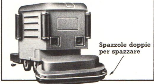
E' in corso di realizzazione un robot mobile industriale per pulire i pavimenti. Oltre a sensori di navigazione, probabilmente disporrà di un sensore per accorgersi di quando l'acqua è sporca.
