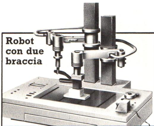
Yes-Man è stato progettato per lavorare accanto agli esseri umani in una catena di montaggio. Le sue braccia gli consentono di effettuare complicate operazioni di assemblaggio; può addirittura fare due cose per volta. La base contiene i microcomputer di controllo.
