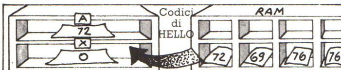
Nella prima linea il computer pone 0 nel registro X; la seconda istruzione usa l'indirizzamento con indice, sommando il contenuto del registro X all'indirizzo fornito
