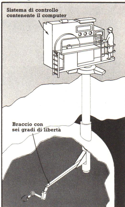
Questo robot a braccio è stato progettato per essere utilizzato nel nucleo di un reattore nucleare. Il braccio è sospeso ad una lunga catena vuota, attraverso la quale passano i cavi di controllo.
