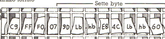
CMP nella terza linea fa confrontare al computer il byte nell'accumulatore con &FF (esadecimale di 255), il segnale di fine del messaggio. Se sono uguali pone lo zero flag a 1. L'istruzione seguente, BEQ, sta per "dirama se uguale" (cioè se lo zero flag è 1);
