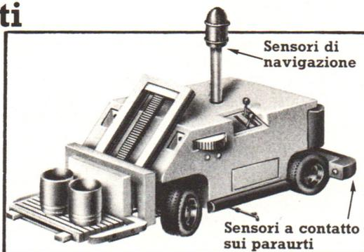
Questo è un carrello elevatore automatico che verrà utilizzato in un magazzino o una fabbrica automatizzata. E' provvisto di un computer e di un alimentatore e si sposta utilizzando sensori.
