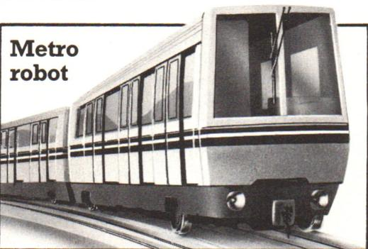
A Lilla, in Francia, è stato fabbricato un treno-robot completamente automatico. Le locomotive cambiano binario e si fermano alle stazioni sotto il controllo del computer.
