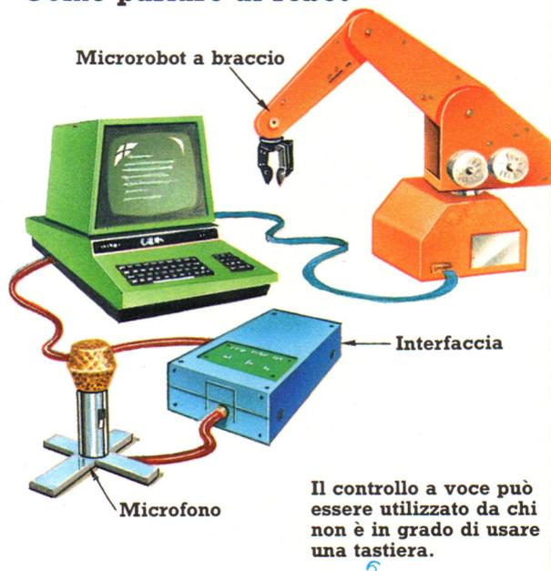
Sono in corso esperimenti su come controllare i robot con istruzioni a voce. Lo si fa collegando un microfono al computer tramite un'interfaccia speciale che trasforma i comandi come "in alto" o "in basso" in una serie di segnali elettrici che il computer è programmato a riconoscere come istruzioni per il robot.
