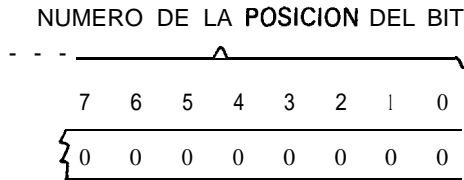
Figura 1.8. Numeración de las posiciones del bit
