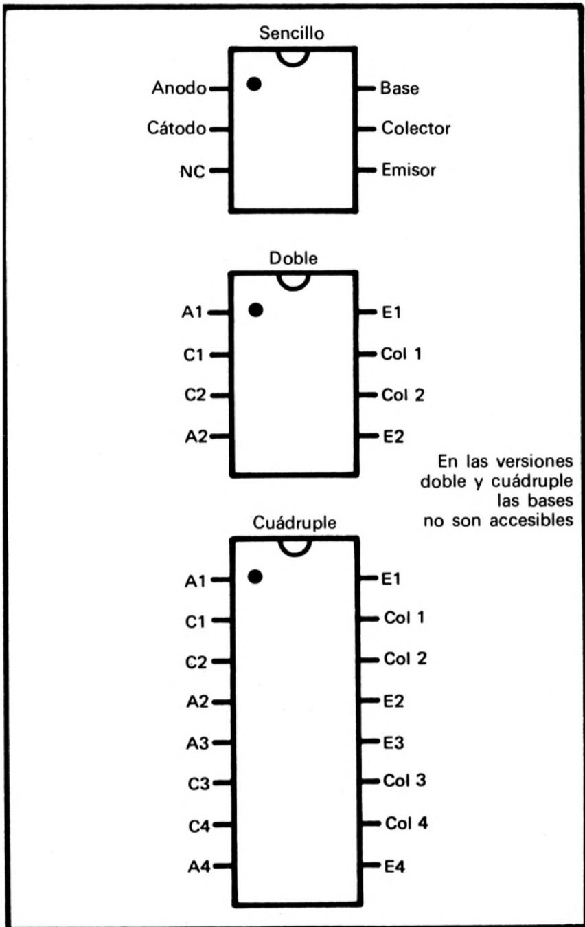
Figura 24.—Patillajes de opto-aisladores sencillos, dobles y cuádruples
