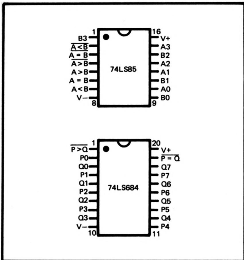
Figura 5.—Patillajes del 74LS85 y del 74LS684
