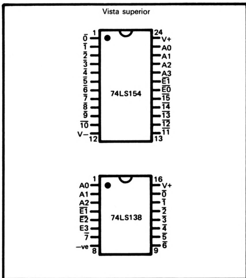
Figura 4.—Patillajes del 74LS138 y del 74LS154
