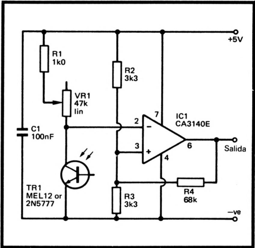
Figura 62.—Circuito detector de nivel de luz
