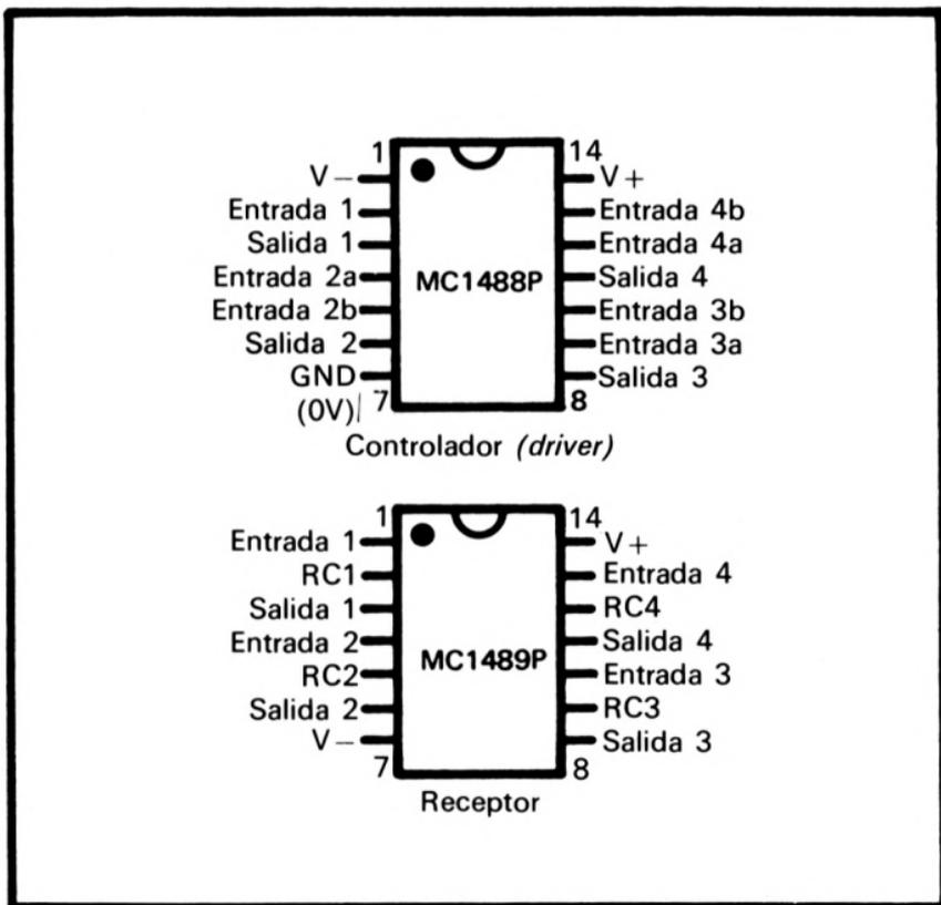
Figura 18.—Patillaje del MC1488P y MC1489P
