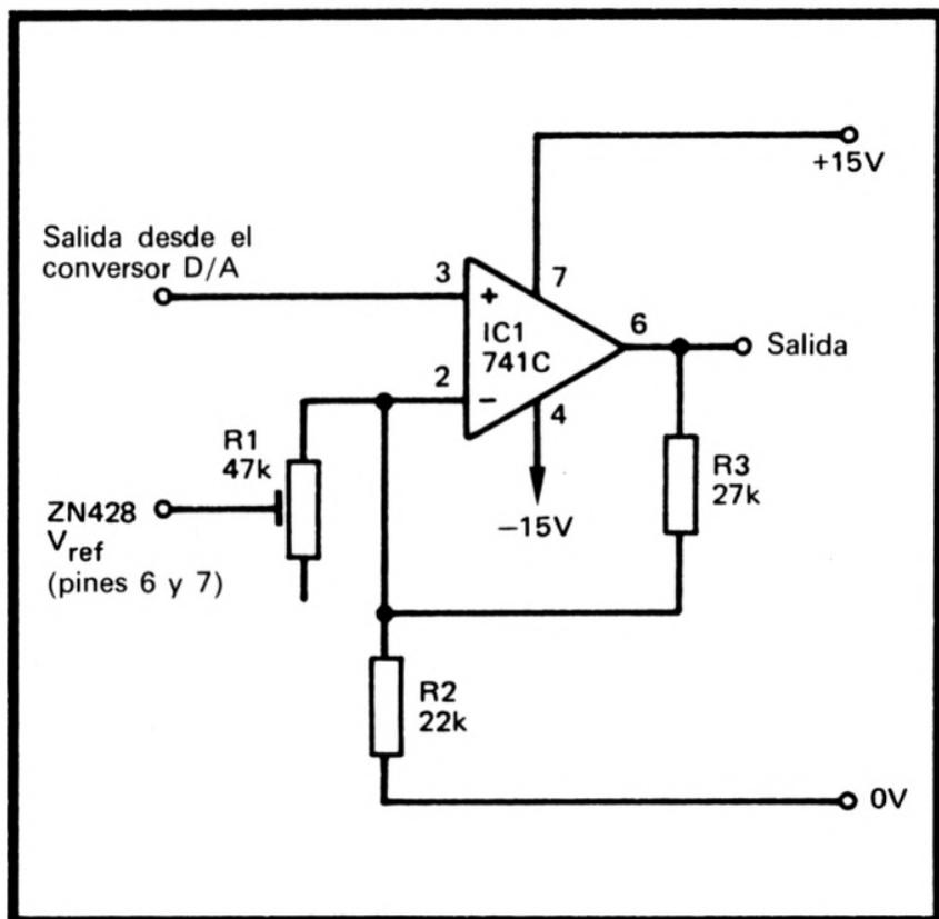
Figura 68.—Circuito de conversión unipolar a bipolar
