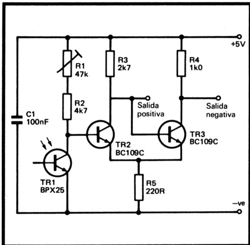
Figura 65.—Diagrama circuital del lápiz óptico
