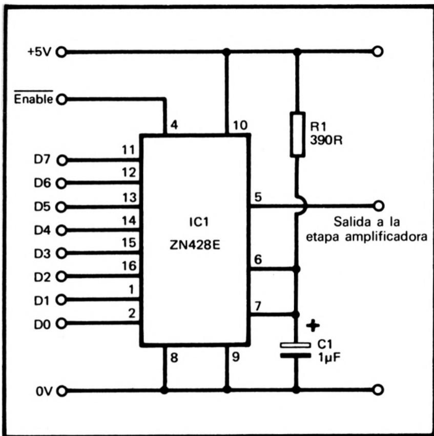
Figura 31.—El conversor digital a analógico básico con el ZN428E
