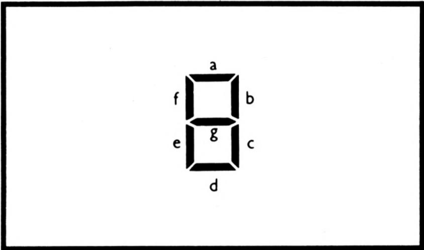
Figura 54.—Esquema usado en un display LED de 7 segmentos
