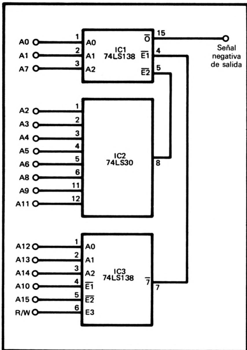
Figura 6.—Circuito de decodificación de direcciones de demostración
