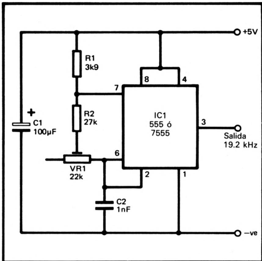
Figura 14.—Un oscilador de reloj para el 6850
