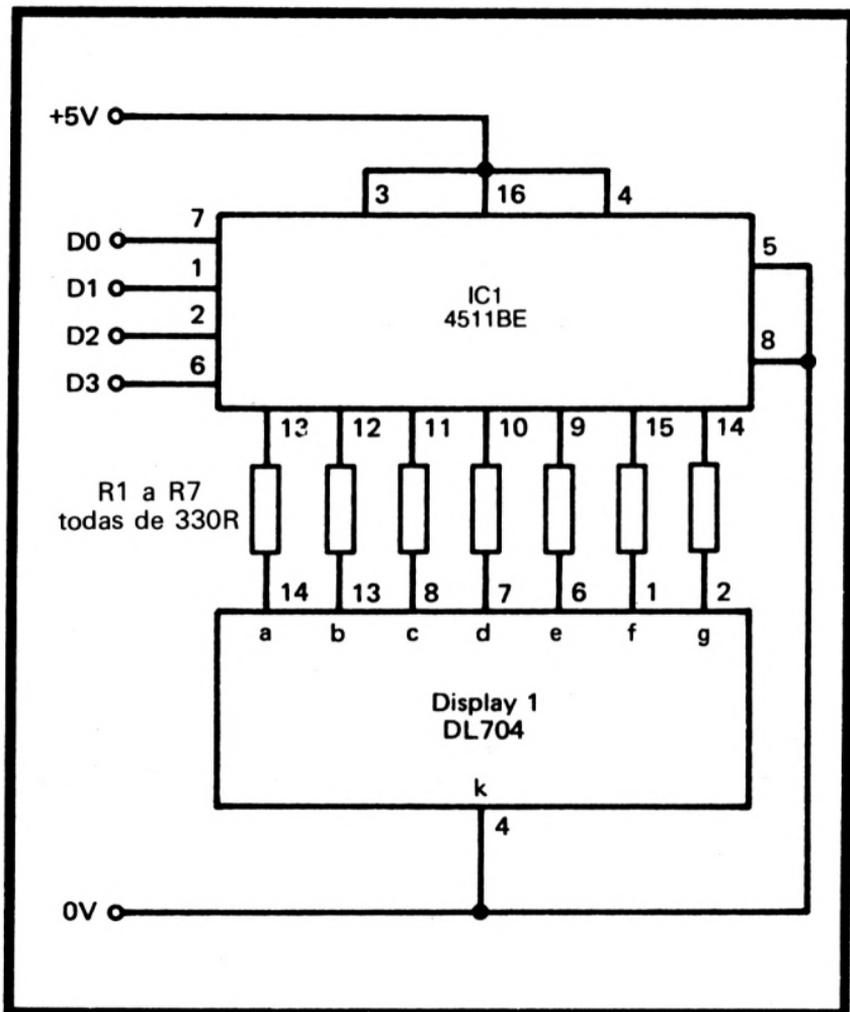
Figura 55.—Circuito decodificador/controlador de display de 7 segmentos
