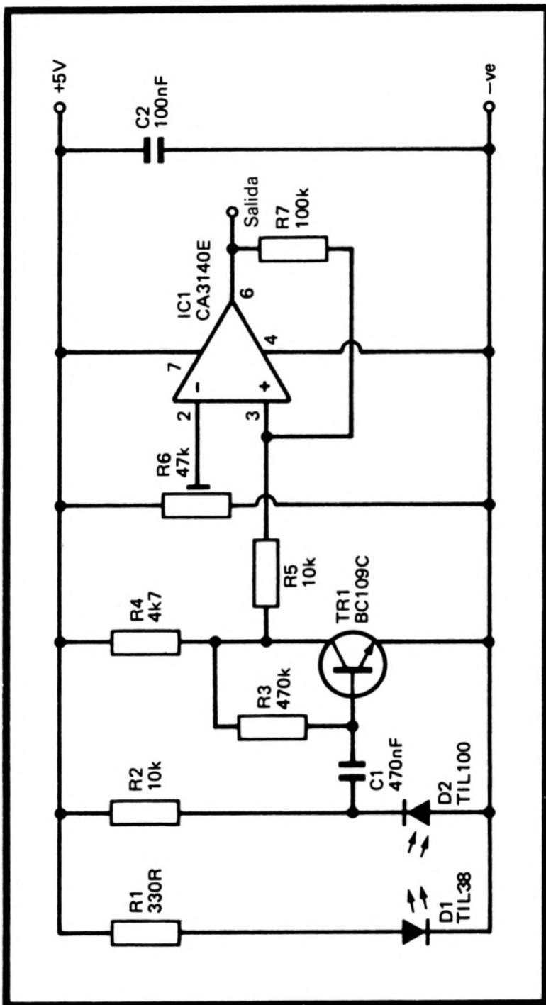
Figura 56.—Simple circuito contador opto-eléctrico
