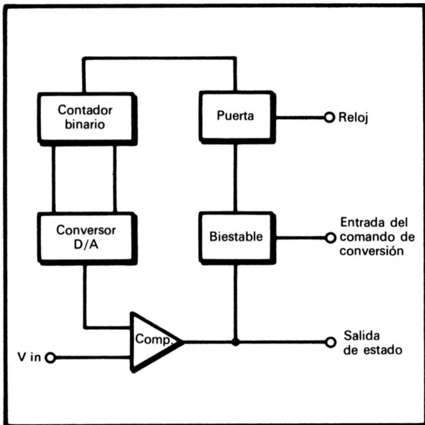
Figura 32.—Esquema usado en un convertor A/D
