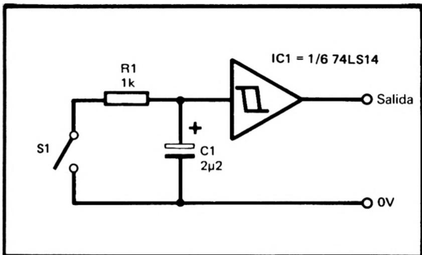
Figura 27.—Circuito eliminador de rebotes simple, pero efectivo
