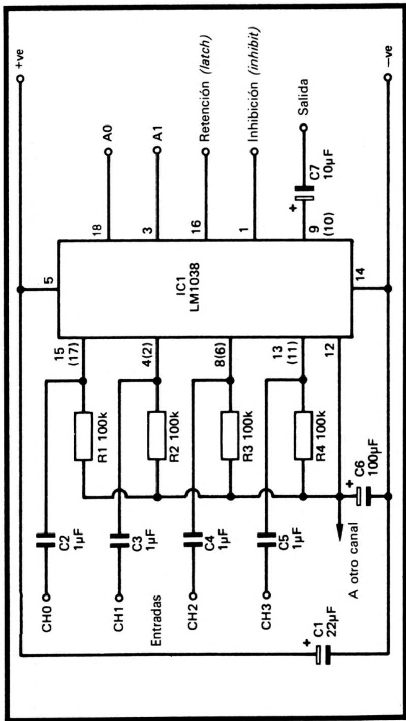
Figura 49.—Selector de canales con un LM1038
