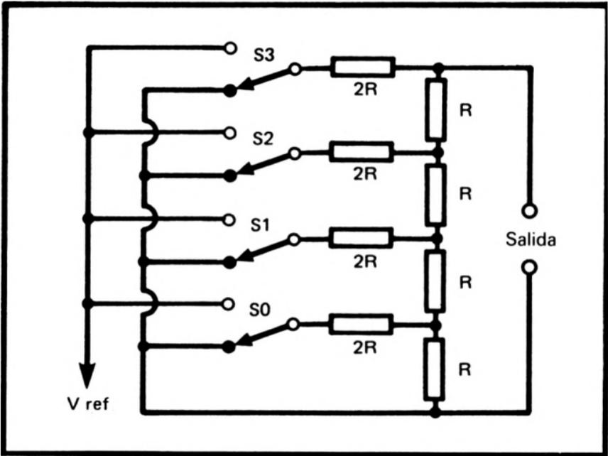
Figura 28.—Unos interruptores electrónicos y una red resistiva producen un efecto D/A
