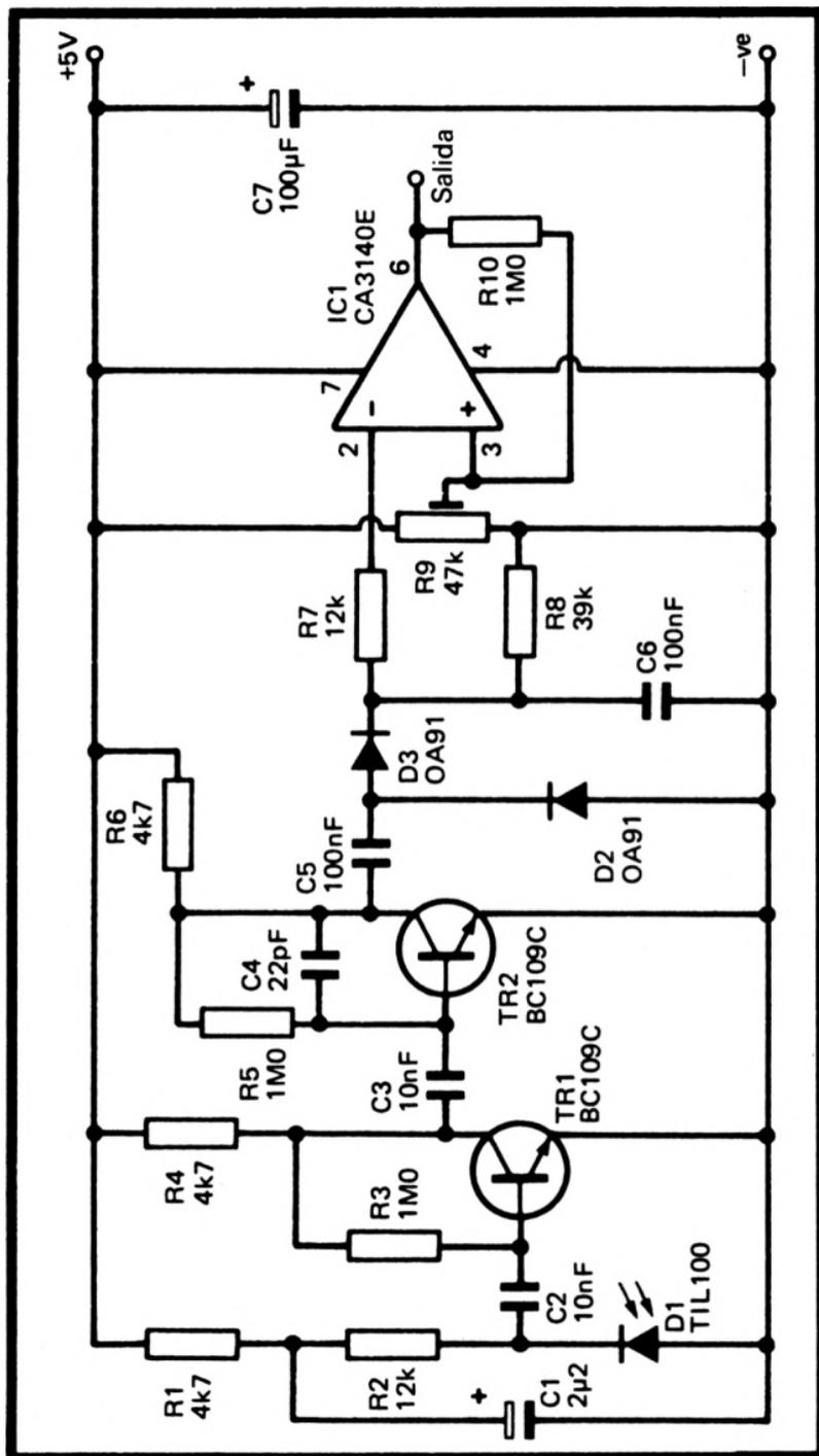
Figura 60.—Circuito del receptor de eco
