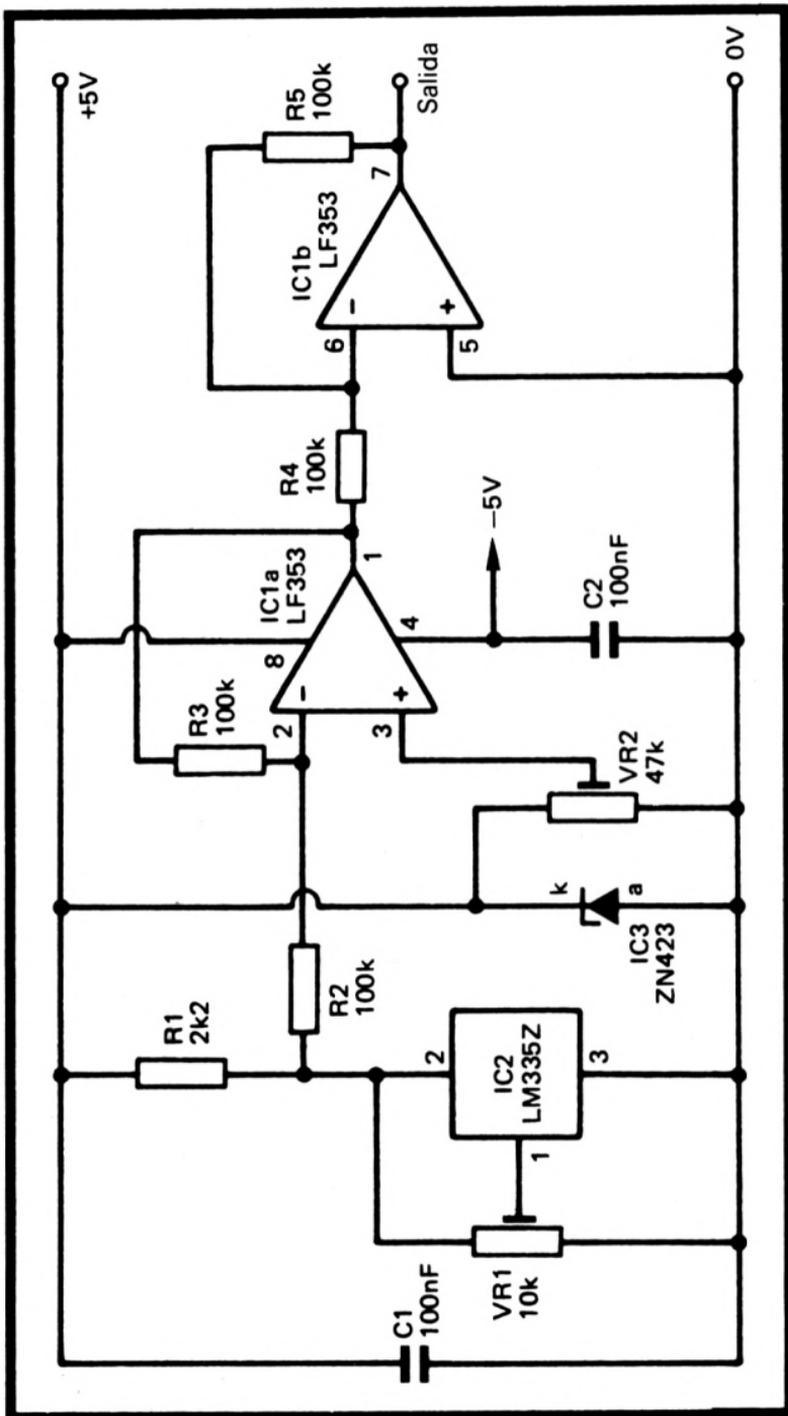
Figura 64.—Un versátil circuito sensor de temperatura
