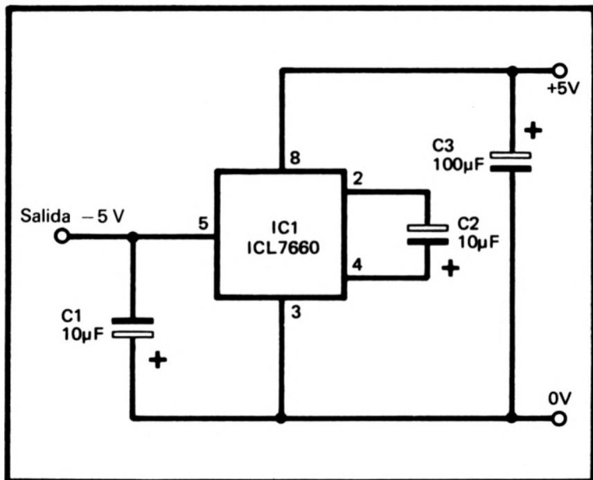
Figura 37.—Generador de alimentación negativa de alta eficiencia
