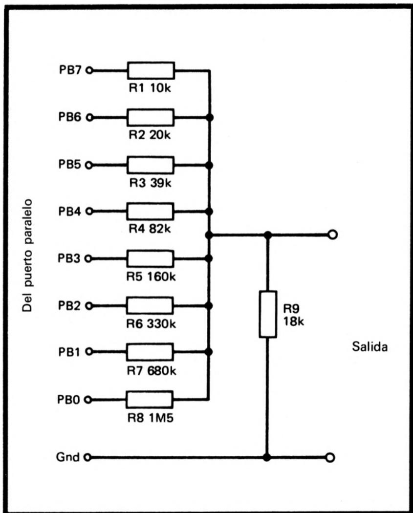
Figura 47.—*Convertor D/A para generación de señales de audio*
