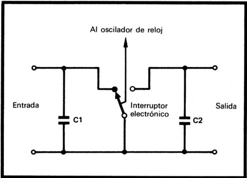
Figura 50.—Esquema básico usado en un filtro digital
