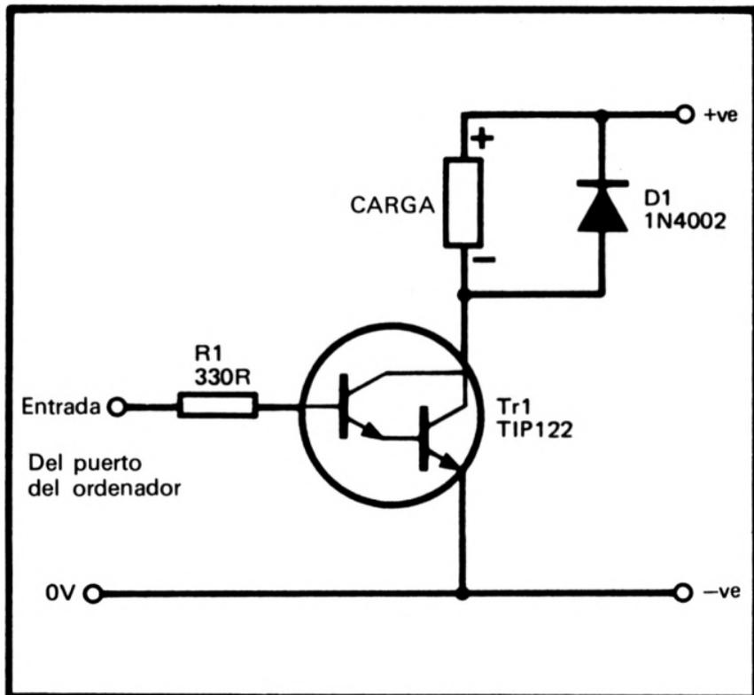
Figura 21.—Circuito controlador Darlington de alta corriente
