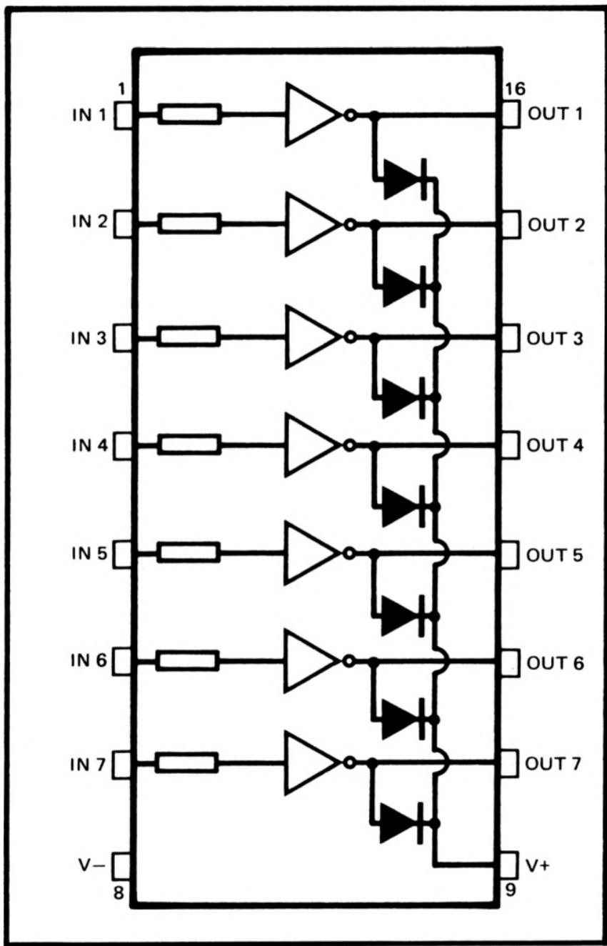
Figura 20.—Patillaje del ULN2003
