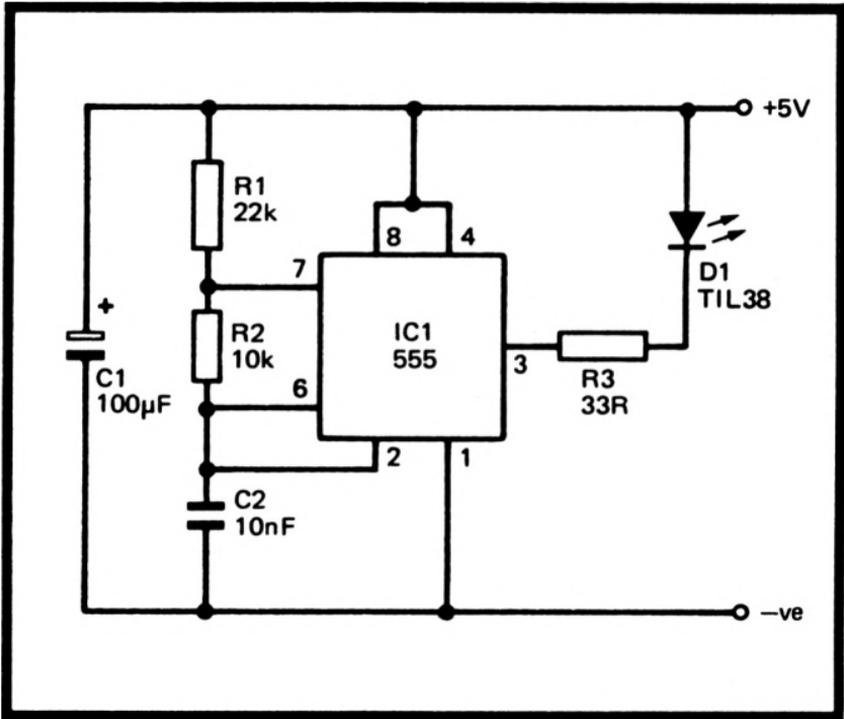
Figura 59.—Circuito del transmisor
