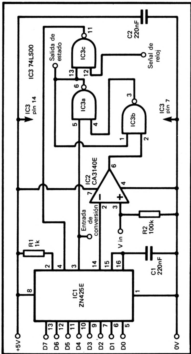
Figura 33.—El ZN425 usado como conversor A/D
