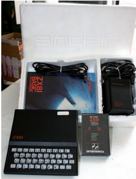
FIGURA 2.51. EL ZX81 EN SU CAJA, CON EL TRANSFORMADOR, CABLES DE VÍDEO Y CASSETE Y SUS MANUALES.
