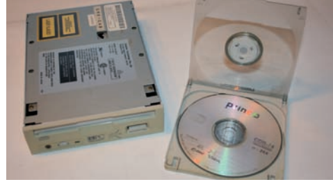
FIGURA 2.12. UNIDAD DE CD Y A LA DERECHA LA CARCASA PARA INTRODUCIR LOS DISCOS.
