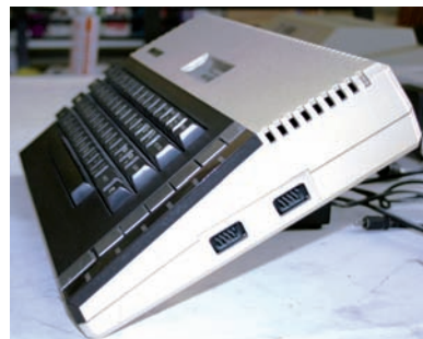
FIGURA 2.40. LOS CONECTORES PARA JOYSTICK SE DESPLAZAN AL LATERAL Y SE REDUCEN A DOS.
