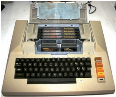
FIGURA 2.36. EL TECLADO DEL ATARI 800 ERA MECÁNICO Y CONTABA CON DOS RANURAS DE CARTUCHOS, APARTE DE VARIOS SLOTS DE EXPANSIÓN.
