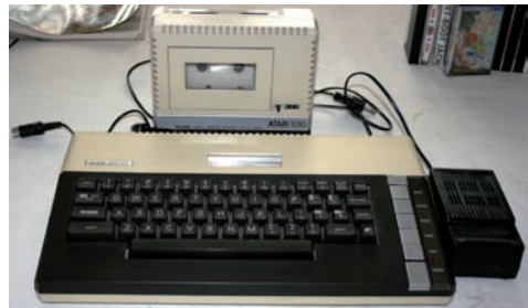
FIGURA 2.39. EL ATARI 800XL CON SU TRANSFORMADOR Y UNIDAD DE CASETE.
