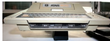
FIGURA 2.35. LA PARTE DELANTERA DEL ATARI 400 CONTABA CON CUATRO CONECTORES PARA JOYSTICK.
