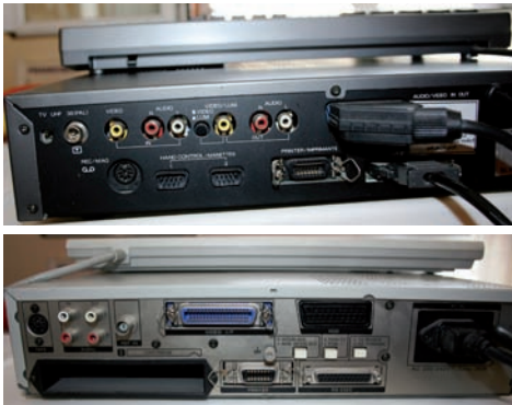
FIGURA 2.90. CONEXIONES DE VÍDEO DEL PHILIPS NMS 8280 (ARRIBA) Y EL SONY HB-G900 (ABAJO).
