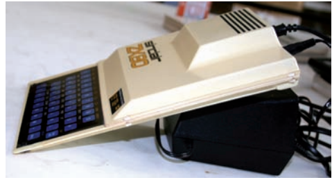
FIGURA 2.47. EL SINCLAIR ZX80 ERA EXTREMADAMENTE DELGADO COMO SE APRECIA EN ESTE PERFIL.
