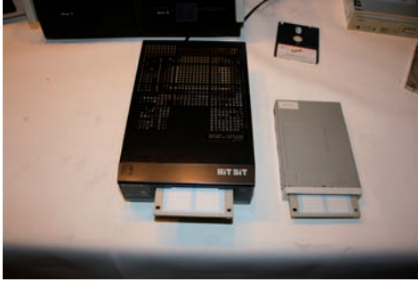
FIGURA 2.6. UNIDAD DE DISCO DE 3.5" EXTERNA SONY (IZQDA.) E INTERNA DE PC (DCHA.).
