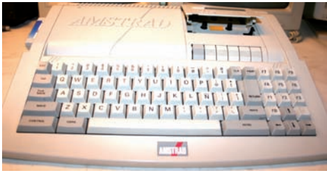
FIGURA 2.71. EL AMSTRAD 464PLUS CON LA TAPA DE LA UNIDAD DE CINTA ABIERTA.
