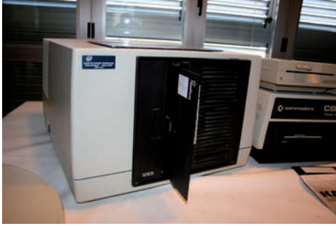
FIGURA 2.4. UNIDAD DE DISCO DE 8" DE UN RANK XEROX 820.
