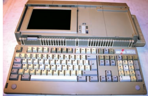
FIGURA 2.130. EL AMSTRAD PPC512 TRAS ABRIR EL TECLADO.
