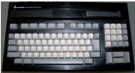
FIGURA 2.75. MITSUBISHI ML-FX2: EL TECLADO TIENE UN ÁREA NUMÉRICA.
