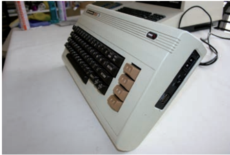
FIGURA 2.18. VISTA LATERAL DEL VIC-20 MOSTRANDO EL INTERRUPTOR DE ENCENDIDO Y CONECTOR PARA JOYSTICK.
