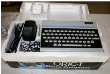
FIGURA 2.100. EL ORIC 1 CON SUS CABLES Y TRANSFORMADOR.
