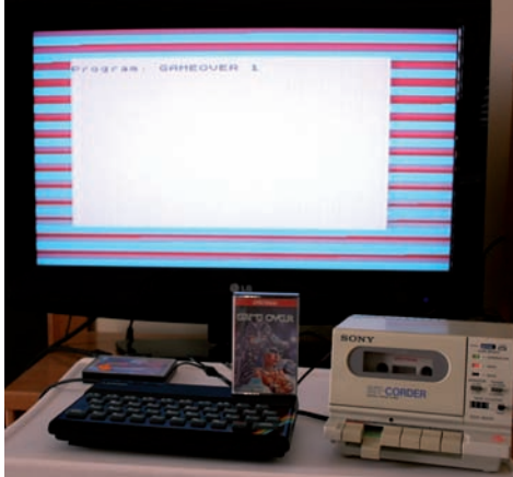
FIGURA 2.54. EL ZX SPECTRUM CARGANDO UN JUEGO DESDE CINTA Y MOSTRANDO LAS TÍPICAS BANDAS DE COLORES.
