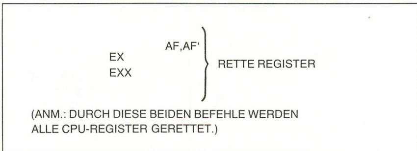
**Abb. 5.4:** Eine Alternative zum Retten der Z80-internen Register.
