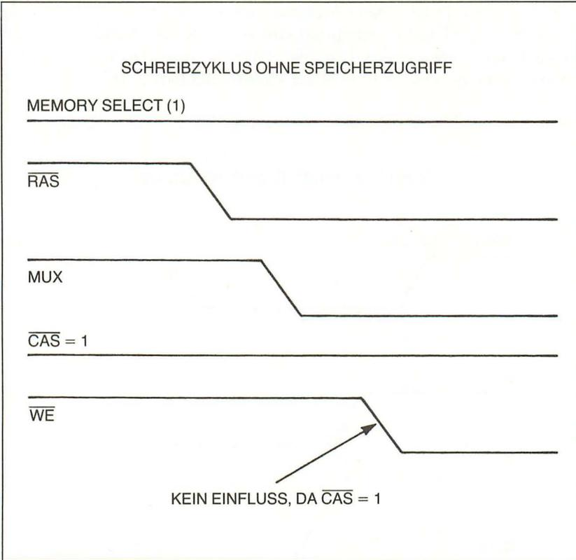
**Abb. 4.12:** Timing für ein nicht angesprochenes dynamisches RAM bei einem Schreibzyklus. Da die Speicher-Zugriffs-Leitung logisch 1 bleibt, wird auch kein  $\overline{\text{CAS}}$ -Signal generiert.
