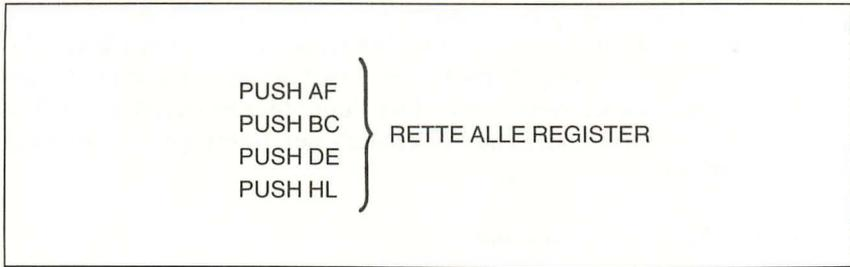
**Abb. 5.3:** Der typische Anfang einer Interrupt-Service-Routine.
