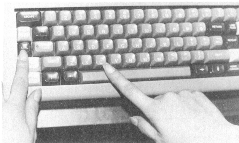
Figura 1.13: Il tasto di controllo C genera una "partenza a caldo"
