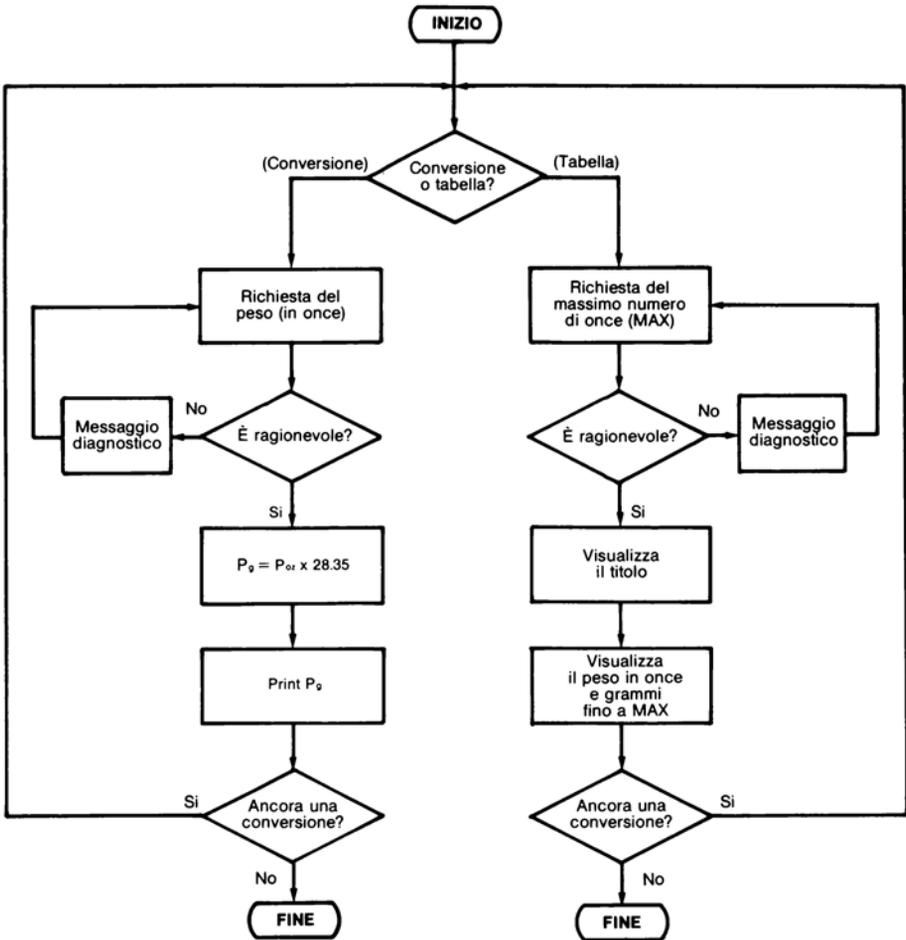
**Figura 9.1 - Diagramma di flusso di conversione dei pesi.**
