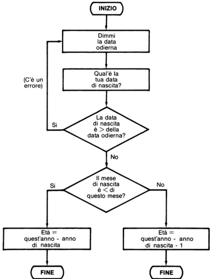
**Figura 8.2** - Diagramma di flusso per il calcolo dell'età.
