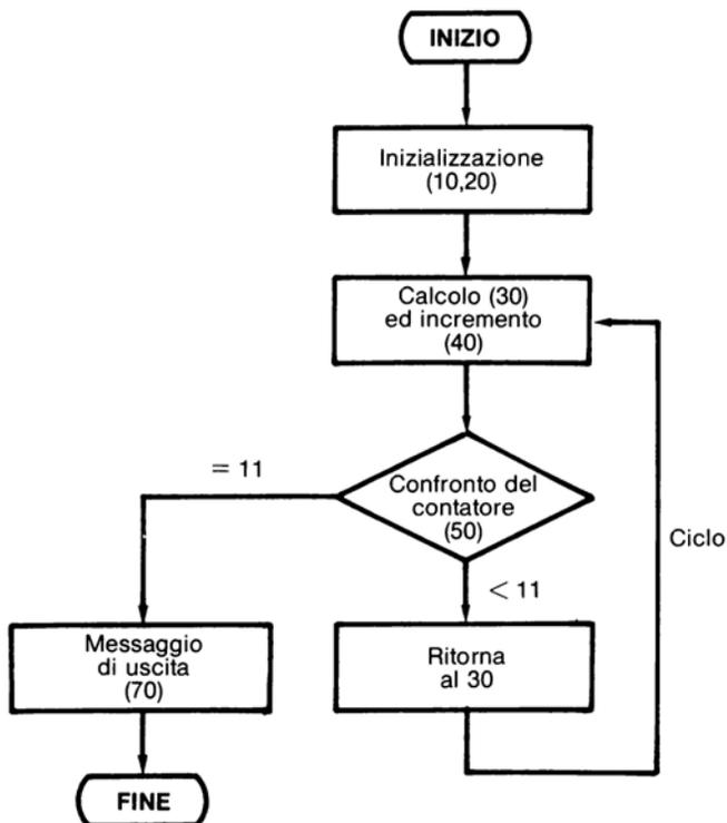
Figura 7.1 - Diagramma di flusso del programma SOMMA dei numeri interi.
