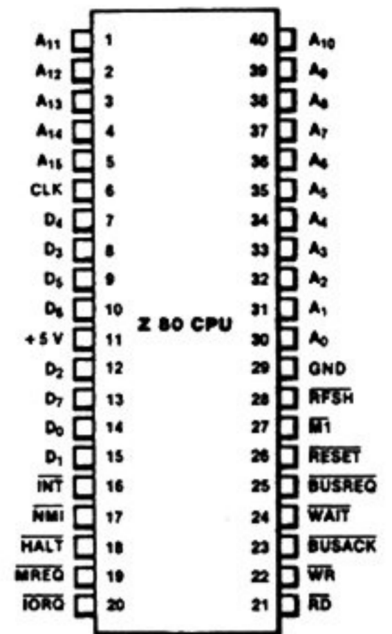
〈図12〉 Z80 CPUの各ピンの信号
