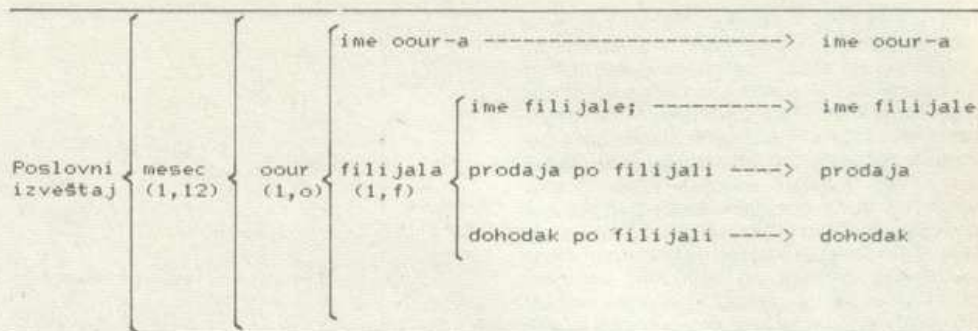
Slika 30. Formiranje fizičke baze podataka ekstrahovanjem primarnih podataka
