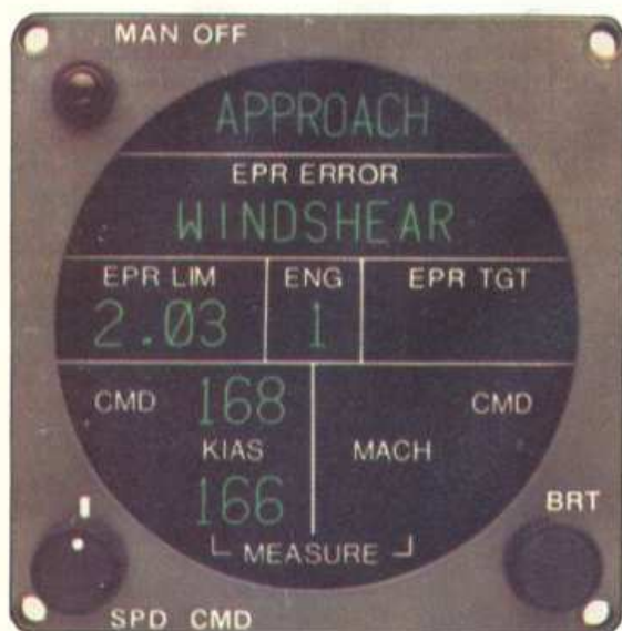
Pokazivač Sperryevog računara koji ima mogućnost detekcije i indikacije smicanja vjetra.
