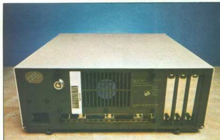
Sva standardna vrata vode od matične ploče i zato su sada otvori slobodni za dalja proširenja. Sleva nadesno: priključci za tastaturu, miš, dvosmerni Centronics, RS 232C i video izlaz. Ventilator, ugrađen u sredini, skoro se i ne čuje.
