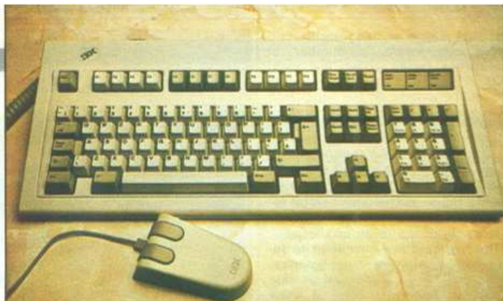
Nova tastatura sa 102 tastera predstavlja poboljšanje standarda AT/E. Sada su odvojeni numerički tasteri od kursorskih tastera, i ubuduće će očigledno novo jevanđelje biti dvanaest funkcijskih tastera. I elegantan miš je standardni deo.
