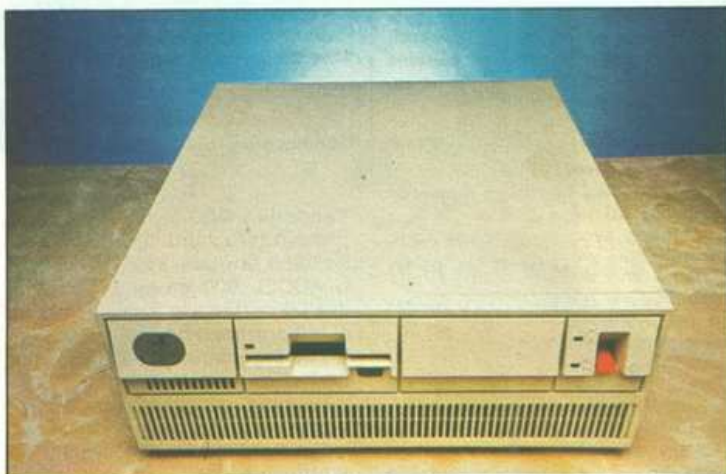
Za nove mašine IBM karakteristično je da nisu više onako »pozamašne« kao raniji PC-i. To važi i za novi disk-pogon od 3,5 inča za koji nam se čini da će se zadržati. Glavni prekidač se preselio na prednji deo, a brava je nazad.
