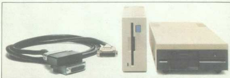
Sredstva za prenos podataka između IBM PC i PS/2: levo je paralelni printerski kabl interfejsom za podatke, na sredini je 3,5-colska i desno 5,25 spoljna disketna jedinica.
