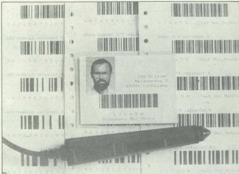
Slika 6: U toku testiranja, svetlosno pero je pročitalo 2.400 linijskih kodova. Tako su interfejsi položili ispit, na koji proizvodi na našem tržištu obično nisu navikli.
