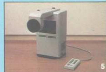
Slika 2: Dataskop C1 je smješten u kompaktno kućište s tri projekcijska otvora i minimalnim brojem korisničkih komandi. Na računalo je spojen samo jednim kablom i nakon kratkog podešavanja spreman je za rad.
