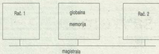
Slika 2a: Starija koncepcija višeprocorskih sistema.
