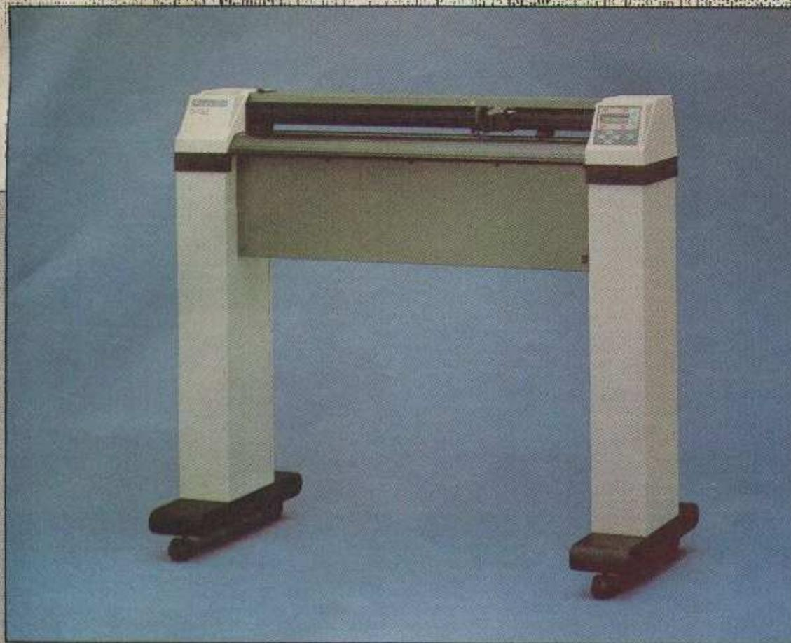
Ploteri serije DPX mogu da crtaju s najvećim brzinama 56 cm/s i imaju crtaču površinu pravljenu od specijalnoga aluminijumskog sača (Honeycomb), što crtačoj površini daje vanrednu krutost i otpornost na deformacije, te omogućava elektrostatičko držanje hartije. U unutrašnjosti ima ugrađena tri procesora (dva 16-bitna i jedan 8-bitni), 1 Mb ulazne memorije, serijski i paralelni interfejs s automatskim raspoznavanjem načina i parametara prenosa podataka. Podržavaju RD GL i DXY GL grafičke jezike.
