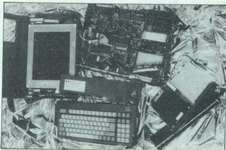
Slika 3. Komplet svih delova: akumulatori, disk i disketna jedinica, kućište sa štampanim kolima, tastatura i rastavljeni ekran.
