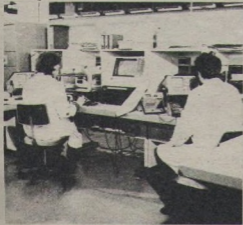
„Sestica“ u funkciji testiranja logičkih ploča elektronike računara.
