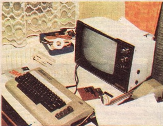
Commodore 64 sa hardverom razvojnog sistema
