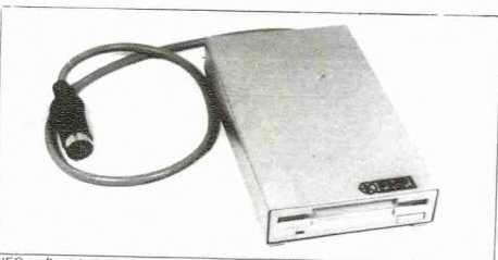
NEC-ov floppy disk s kojim se disketa može formatirati do 1 Mb
