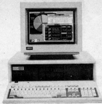
Najbrži klon na svetu: U Compaq DeskPro ugrađen je procesor 80386 na 20 MHz
