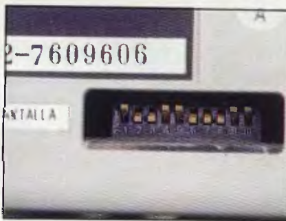
Detalle del panel de Microswitches. Ajustándolos, el 1640 sabe qué tipo de monitor tiene unido.
