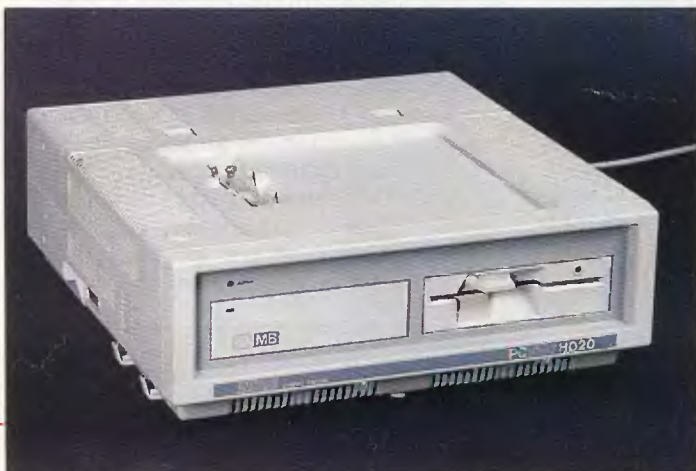
El corazón del 1640: la unidad central. Véase el disco de 20 Megas, que confiere al ordenador una insospechada potencia.
