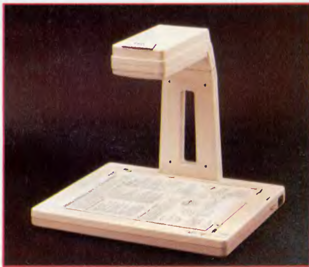
El scanner del FCS se sale de lo corriente, ya que no realiza el barrido por fricción, sino desde un plano superior al del original.
