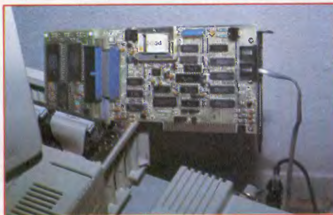
La tarjeta que incluye el Kit FCS se inserta fácilmente en cual de expansión del Amstrad PC y deja al exterior las conexiones con la línea telefónica.
