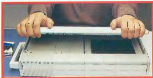
Comienzo de una sesión de trabajo. El PPC se encuentra cerrado. La tapadera es el mismo teclado, la pantalla se encuentra plegada sobre la unidad central.
