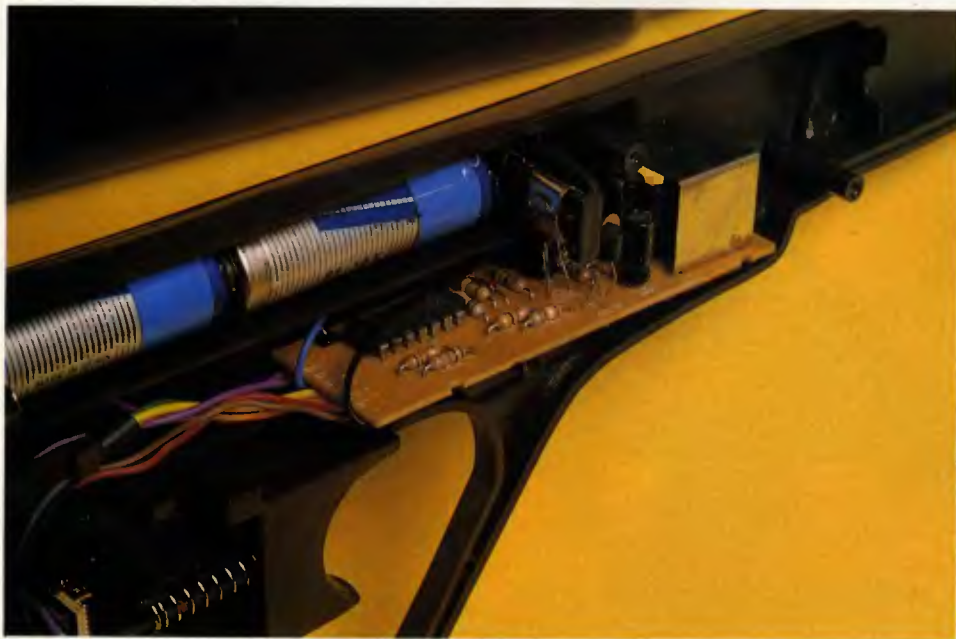
Detalle del circuito y del blindaje del «Foto Darlington».
