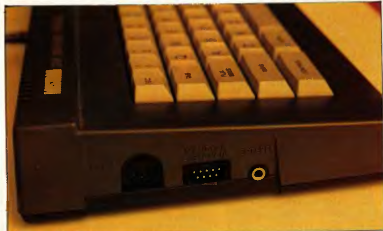
En esta foto podemos observar la toma de cassette, la salida de audio y el conector para el joystick de un Amstrad CPC.
