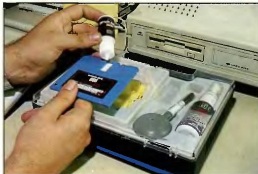
*El disco-implador se rocía con la solución no abrasiva que permite limpiar las cabezas sin desgastarlas.*
