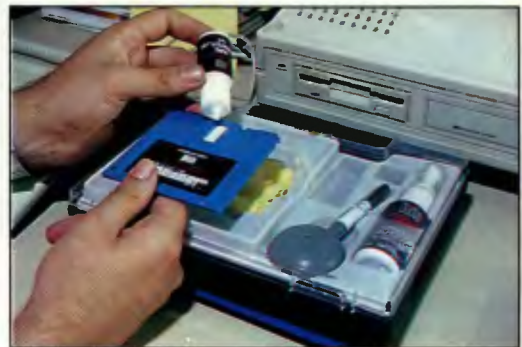
El disco-limpiador se rocla con la solución no abrasiva que permite limpiar las cabezas sin desgastarlas.
