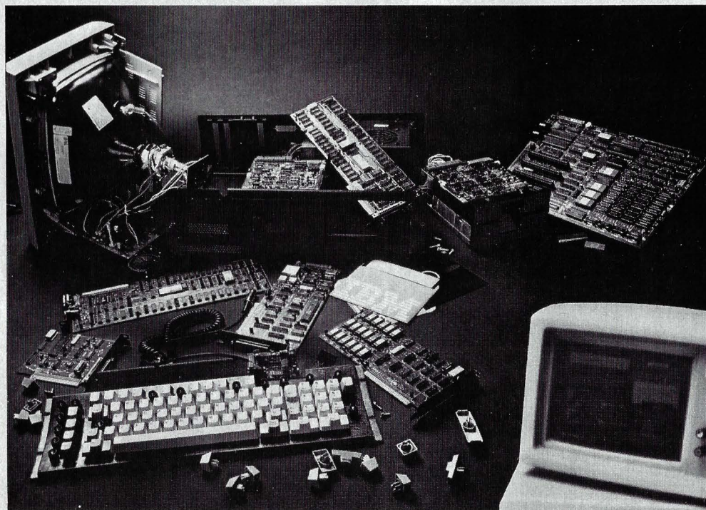
El ordenador desmontado y tal como lo vemos cuando está listo. En el diagrama de arriba se aprecian los más importantes canales de datos hacia el «cuadrado mágico»: pantalla, teclado, grabadora e impresora.
