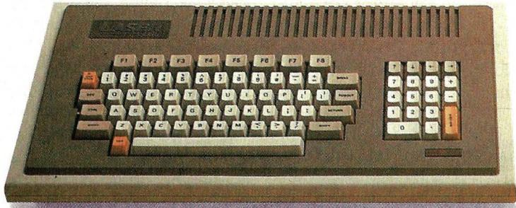
Estos tres ordenadores fabricados en Hong-Kong están especialmente indicados para principiantes que se quieran introducir en el mundo de la informática. El modelo inferior, el Laser 200, dispone de apenas 4 KBytes de memoria RAM, pero se pueden ampliar hasta 64 KBytes. Se trata de un aparato muy económico con una buena relación calidad/precio, aunque tiene dos defectos de relativa importancia: teclado de goma y baja resolución gráfica.
