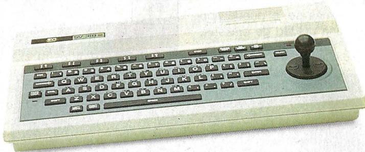
El SV-318 lleva incorporado un *joystick* a la derecha del teclado, que puede usarse como controlador del cursor o como mando para juegos. Su memoria principal de 32 KBytes es ampliable a 80 KBytes y el sistema operativo puede soportar hasta 14 periféricos a la vez. Si se dispone de una unidad de *diskettes* para grabar el sistema operativo, se pueden utilizar programas en CP/M.
