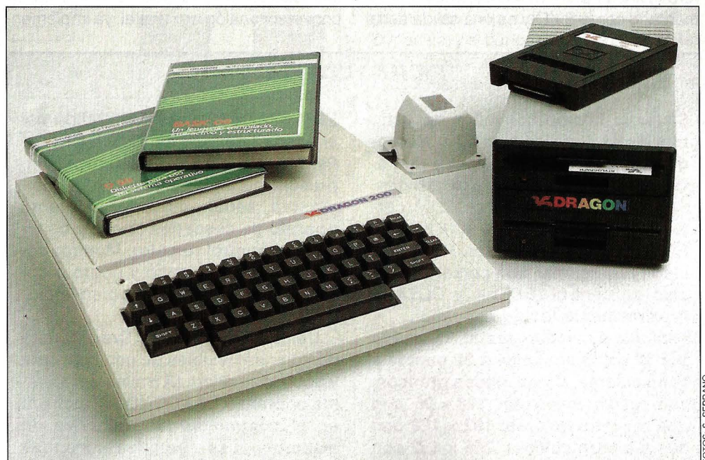
Configuración básica: unidad central (51.700 pesetas), transformador y unidad de diskettes (120.000 pesetas) con controlador (sustituible por un aparato de cassettes convencional).
