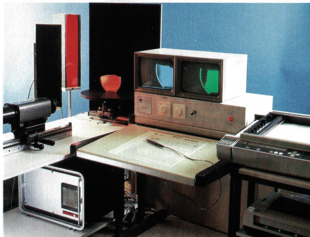
El sistema ARCOS: abajo a la izquierda, el ordenador; sobre él una videocámara y la mesa de muestras. Dos monitores y un plotter completan el equipo.
