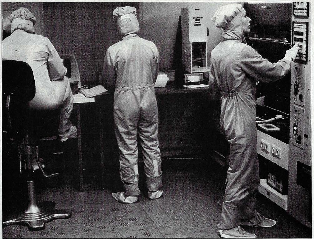
**En los laboratorios de producción se presta la máxima atención a la asepsia: una sola mota de polvo puede inutilizar los circuitos de un chip.**
