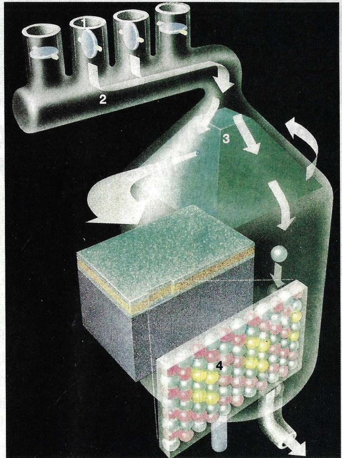
En el sistema por deposición de gases las distintas sustancias (galio, arsénico, aluminio y materiales de dopado) se dosifican separadamente a través de válvulas (1) y se conducen por un tubo común (2) hasta la boquilla de pulverización (3). Las moléculas se van depositando en estado gaseoso sobre la oblea, superponiéndose unas capas sobre otras (4). Los gases de desecho, en parte muy venenosos, se recuperan convenientemente.
