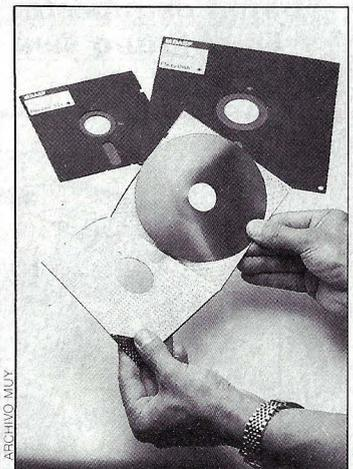
**El calor deforma la funda y el disco.**
