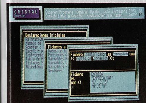
to gráfico y dos de representación de textos. La pantalla abarca 25 líneas de, opcionalmente, 80 ó 40 caracteres, con 16 colores. El modo *Medium Resolution Graphic* permite representar 320x200 puntos de imagen con cuatro colores simultáneos, y el *High Resolution Graphic* alcanza los 640x200 pixels, aunque sólo en dos
