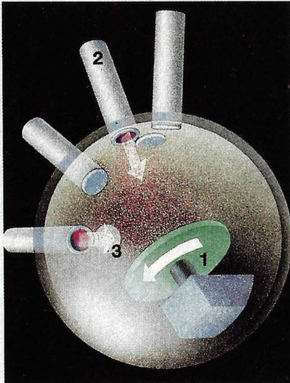
En el sistema por haz molecular varios cañones de moléculas (2) controlados con válvulas (3) bombardean la oblea de GaAs (1).
