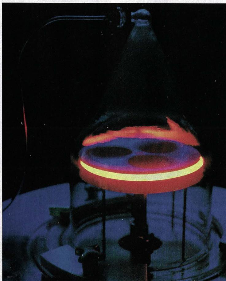
**Recubrimiento en el laboratorio de tres obleas de arseniuro de galio según el procedimiento MOCVD (ver recuadro en página 49). La sustancia de revestimiento se pulveriza desde cierta altura en forma gaseosa. La superficie de las obleas reciben así una capa de sólo algunas moléculas de espesor. El proceso exige máxima pulcritud.**
