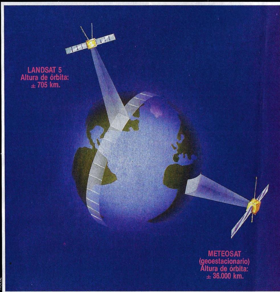
**El Landsat 5 describe una órbita polar para barrer con su scanner la superficie terrestre. Por el contrario, el Meteosat se encuentra siempre en la vertical del mismo punto.**
