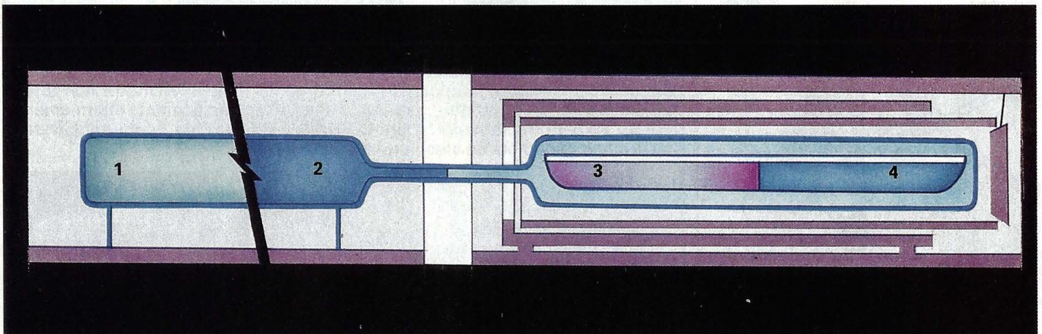
**Así se consigue la combinación del arsénico con el galio. El arsénico sólido (1) es calentado hasta su evaporización (2). Por su parte, el galio sólido (3) llega al punto de licuefacción (4) en un horno independiente. Ahí donde confluye el vapor de arsénico con el galio líquido se forma arseniuro de galio.**
