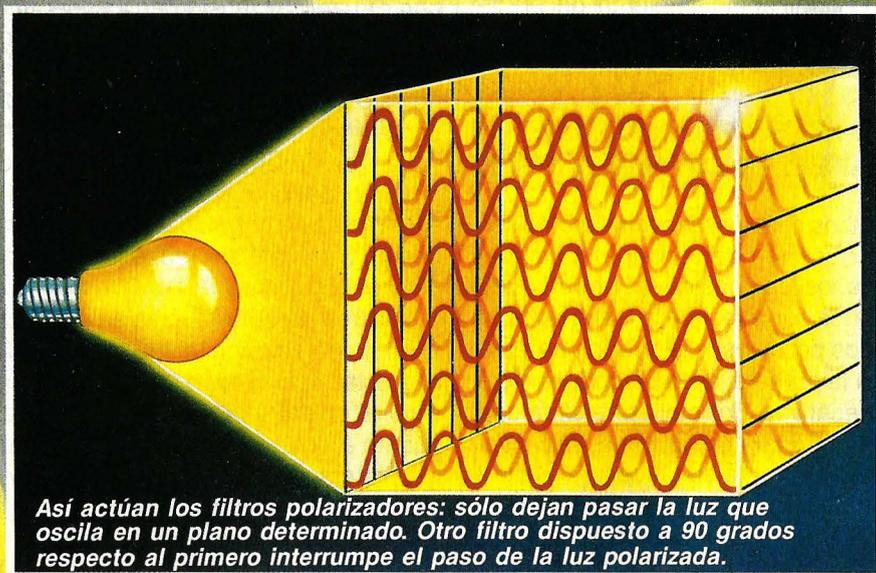
Así actúan los filtros polarizadores: sólo dejan pasar la luz que oscila en un plano determinado. Otro filtro dispuesto a 90 grados respecto al primero interrumpe el paso de la luz polarizada.
