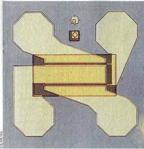
**Amplificador de alta frecuencia de arseniuro de galio fabricado por Siemens. Ya se vende en el mercado.**
