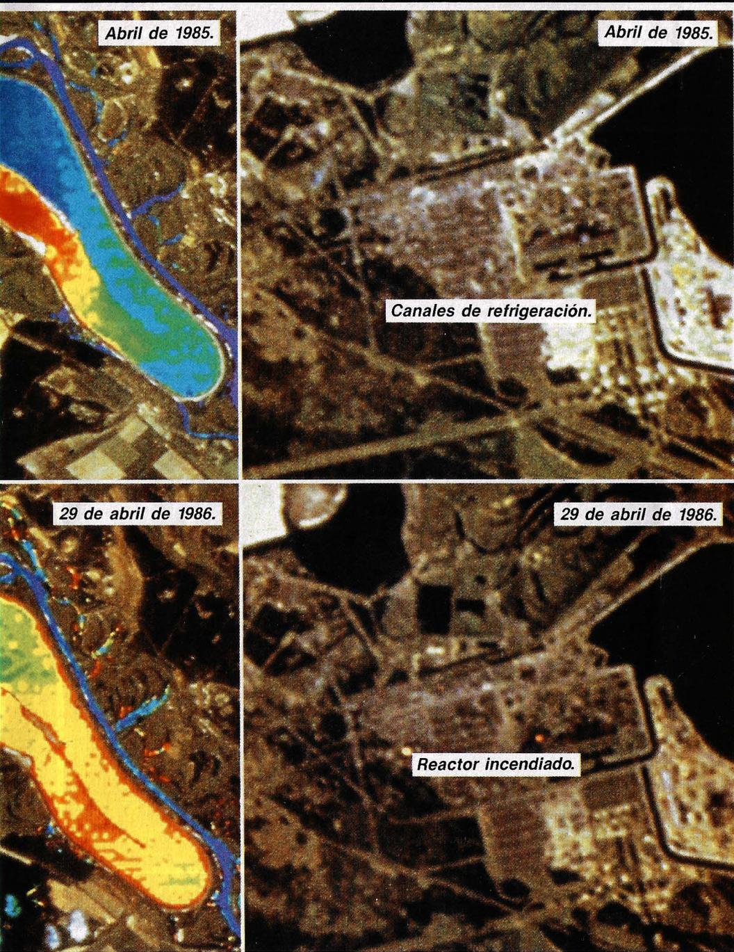
**termografía del estanque de refrigeración (azul=frió; amarillo=caliente) desvela el reactor en funcionamiento y después de desconectado. A la derecha, el punto amarillo muestra el reactor incendiado.**
