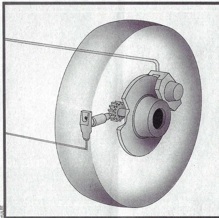
*El sistema antibloqueo ABS ya viene incorporado de serie en algunos automóviles. Un piñón solidario a la rueda genera impulsos electromagnéticos que detecta el ordenador. Cuando siente que ha quedado bloqueada hace disminuir instantáneamente la presión del circuito hidráulico de freno sobre esa rueda.*
