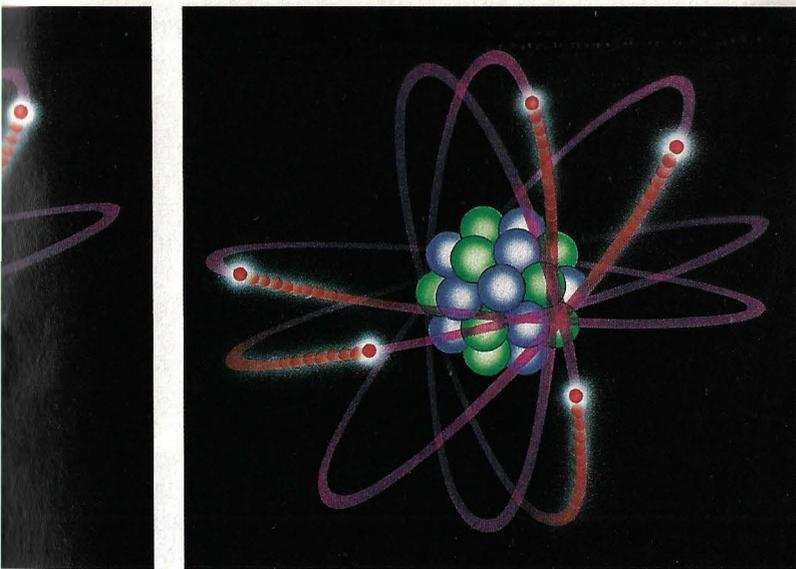
**El átomo del silicio (izquierda) tiene cuatro electrones. El metal galio (centro), solamente tres, pero cuando se combina con el arsénico (derecha), con cinco electrones, éste le presta uno de ellos. El resultado se llama arseniuro de galio.**
