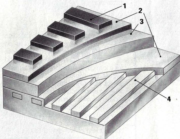
**Sistema de electroluminiscencia: entre dos placas aislantes transparentes (2) se dispone una capa de material semiconductor luminiscente (3). Dos electrodos transparentes también y que forman una cuadrícula de ejes X e Y (1 y 4) suministran la tensión. En los puntos de encrucijada se enciende el semiconductor.**
