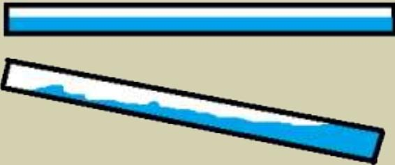
Para que el agua fluya por un tubo, es necesario que exista una diferencia de altura entre los extremos del mismo, si lo inclinamos el agua irá de la parte más alta hacia la más baja, estableciéndose una pequeña corriente de agua que recorre la tubería. De igual manera, si en un circuito hay puntos con mayor potencial eléctrico y puntos con menor potencia, la electricidad recorre el cable, moviendo los electrones desde el punto de mayor potencial al de menor potencial\*.
