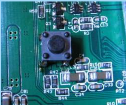
Detalle del botón de modo depuración, instalado por mí. (Gracias a Mcleod_Ideafix)
