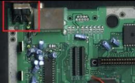
Si volteamos nuestra placa de megadrive, justo bajo esa entrada din 8, encontraremos 8 pequeños puntos estañados, los cuales son las conexiones de la entrada de video din 8, aquí debemos de soldar los cableados a la entrada de euroconector hembra, siguiendo el siguiente esquema:
