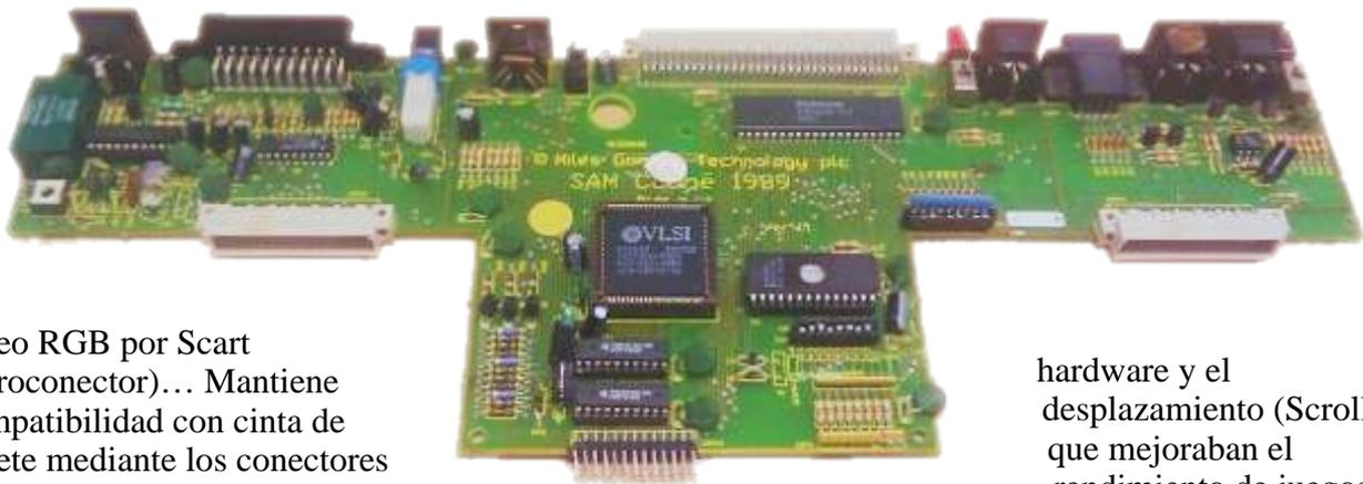
vídeo RGB por Scart (euroconector)... Mantiene compatibilidad con cinta de casete mediante los conectores incluidos y en definitiva, presenta una buena parrilla de conexiones con el mundo exterior
