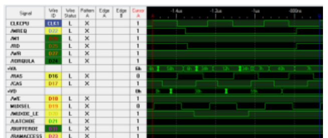
Cronograma de un ciclo de lectura de memoria en una dirección del espacio de ROM
