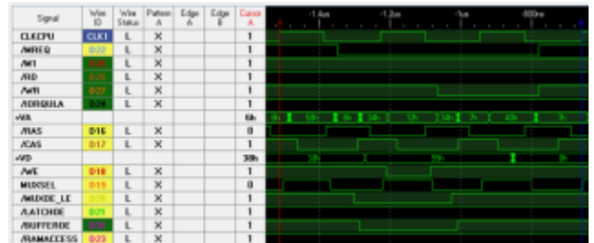
Cronograma de un ciclo de escritura a una dirección de memoria en el espacio de ROM
