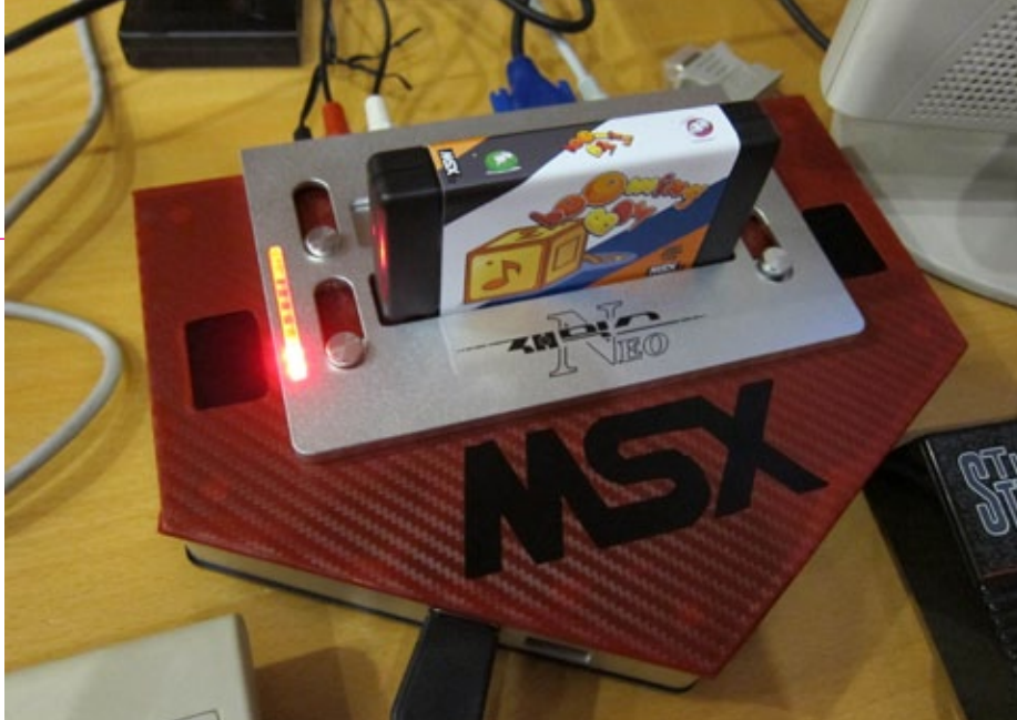
Zemmix Neo Lite. A diferencia del 1ChipMSX original, que era de plástico transparente, este clon coreano tiene una carcasa completamente metálica cortada por CNC, que le confiere un peso considerable y le da un acabado mucho más profesional.
