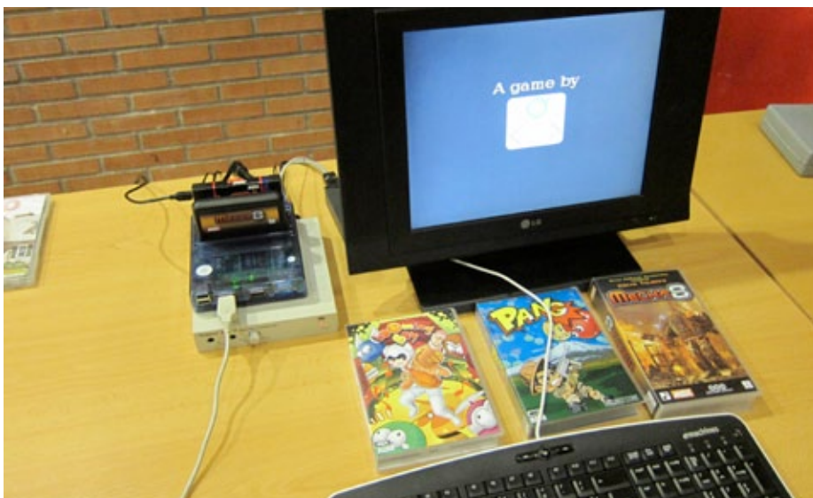
Zemmix Neo Lite. A diferencia del 1ChipMSX original, que era de plástico transparente, este clon coreano tiene una carcasa completamente metálica cortada por CNC, que le confiere un peso considerable y le da un acabado mucho más profesional.
