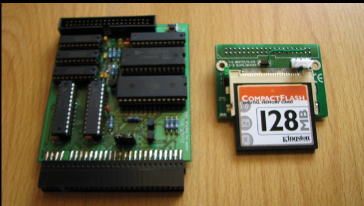
La revolución de la carga de cintas. El diviDE es un dispositivo que, desde hace 15 años, permite que los usuarios de Spectrum se hayan olvidado de las tediosas cargas de cinta, solapando la rutina de carga de la ROM y permitiendo la carga de ficheros .z80 y .tap, entre otros.
