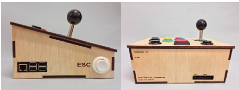
Todas las conexiones al alcance. En uno de los laterales encontraremos puertos USB a tutiplén y el correspondiente conector para red ethernet, mientras que en la parte trasera encontramos los conectores de AV y fuente de alimentación.
