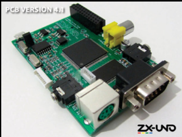
Ejemplo de FPGA. ZX-UNO es un ejemplo de sistema basado en una FPGA Xilinx Spartan con potencia suficiente para clonar, no sólo un Spectrum, sino otros sistemas como Sam Coupé, Jupiter Ace, Sega Master System o Apple II, entre otros.
