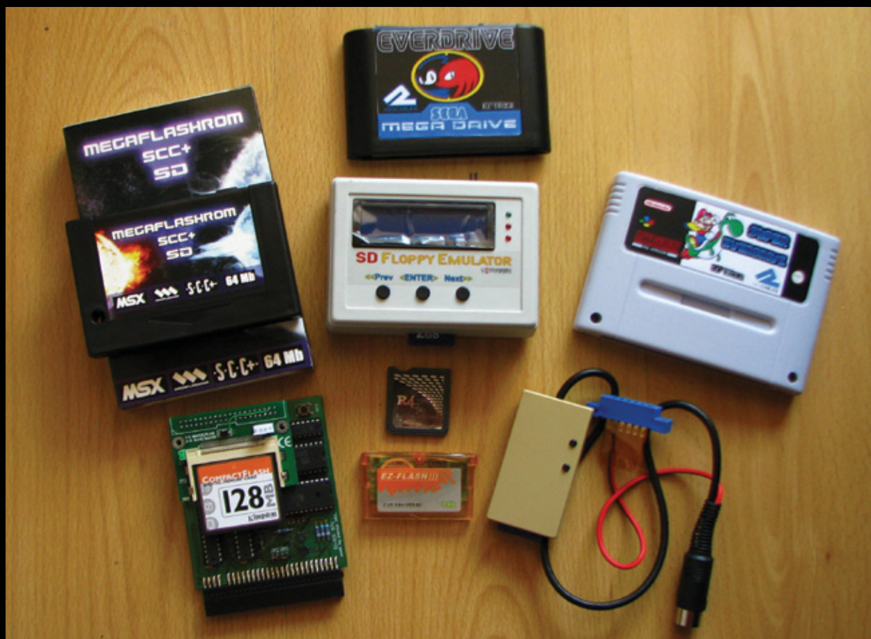
Montones de opciones. De arriba a abajo y de izquierda a derecha: MegaFlashROM SCC++ SD (MSX), Everdrive (Mega Drive), HxC (emuladora de disquetera), Everdrive (SNES), divIDE (Spectrum), R4 (Nintendo DS), EZFlashIII (GBA), SD2IEC (C64).
