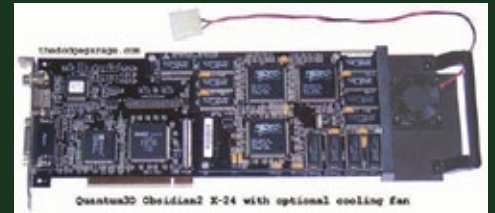
Arriba: Quantum3D ArcadeAMP: Hardware amplificador de audio con una potencia de 20W que no necesita ningún slot de ordenador. Abajo: Obsidian2 X-24: Una de las tarjetas más queridas, Voodoo 2 SLI con 24 MB en sólo slot con un tamaño de 10.5" x 4" x 3/4" y un precio de $626.99 según una factura de septiembre de 1998.
