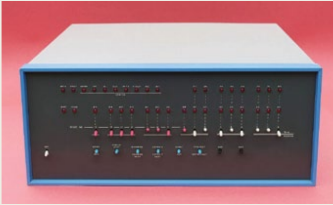
El Altair 8800 no tenía ni teclado, ni pantalla... hoy en día, ni siquiera llamaríamos ordenador a esto. Pero era tecnología punta de consumo. Debajo a la derecha: este juguetito fue el primer microprocesador de la historia, el Intel 4004. Sus prestaciones eran ridículas, pero en su momento fue todo un logro de la miniaturización al poder albergar varias partes de un ordenador en un solo chip.
