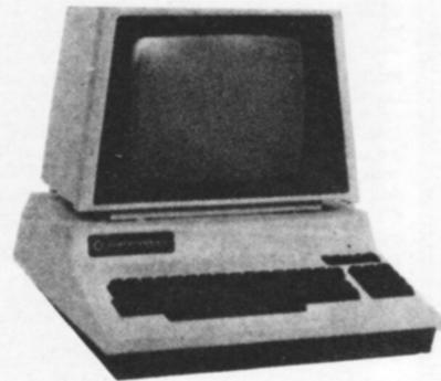
Capacidad 20 K en ROM ampliables hasta 24 K y 5 K en RAM ampliables hasta 32 K.
