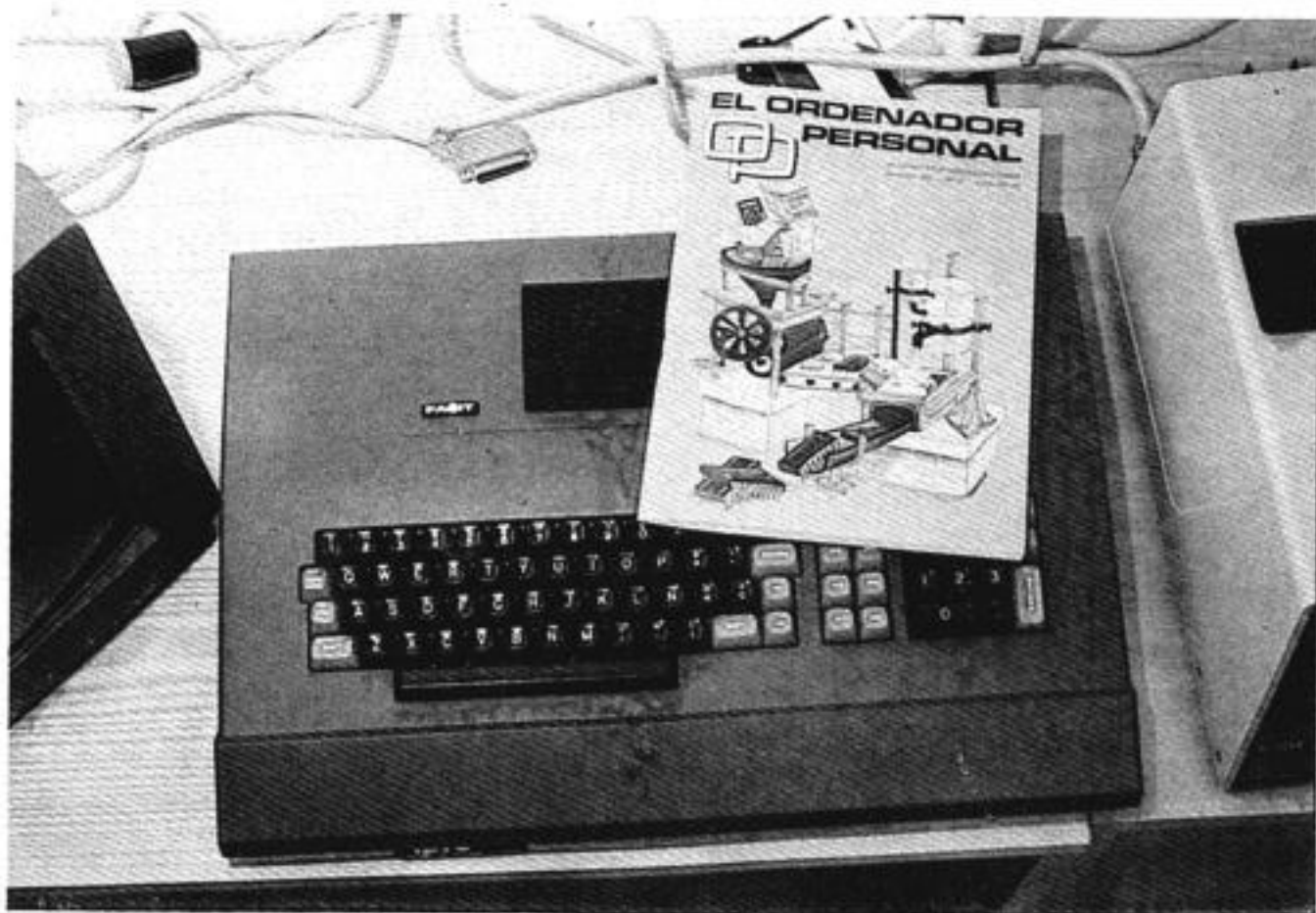
El ordenador FACIT DTC contiene en una unidad, el procesador, circuitos y teclado.
