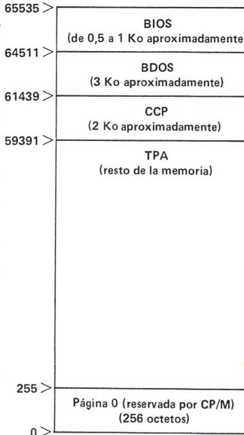
Figura 2.— Estructura memoria de un Sistema CP/M de 64K octetos.
