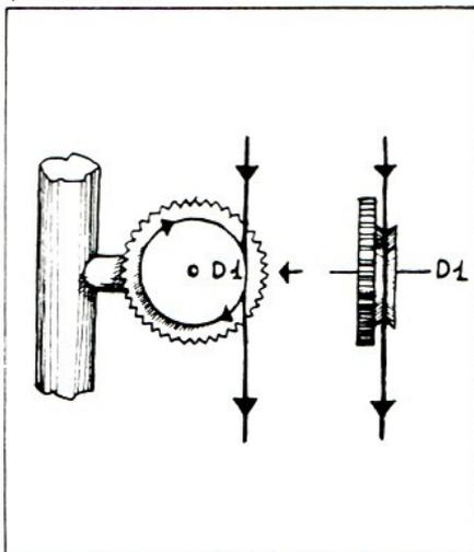
El cable forma un bucle en una polea de garganta, que gira libremente sobre el eje 1. Esta polea es solidaria de una rueda dentada ligeramente más grande. Una cuña que bascula mediante un electroimán, puede alojarse entre los dientes y bloquear así la rotación del conjunto.
