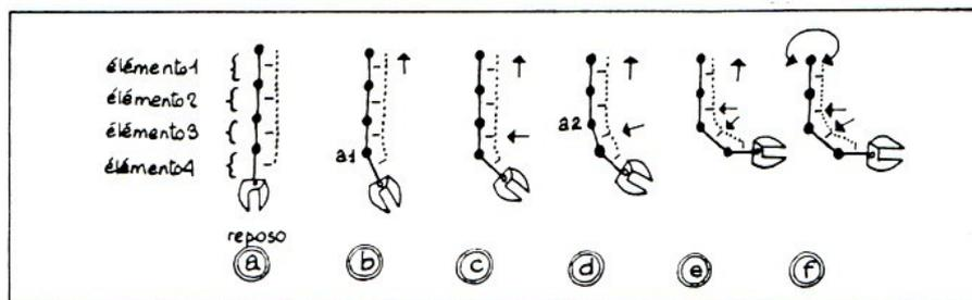
Si se tira del cable (b), el elemento 4 gira alrededor de  $a_1$ . Cuando se alcanza la posición deseada, se bloquea (c). Si se continúa actuando sobre el cable, el elemento 3 gira alrededor de  $a_2$  (d). Se sitúan así sucesivamente todos los elementos (e). Sin embargo con una rotación alrededor de D (f) podemos cubrir el espacio.
