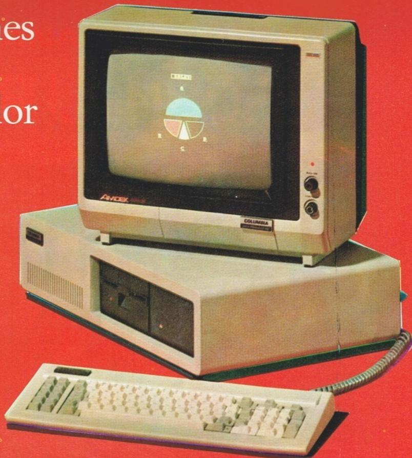
con paridad, doble disco con 640 K en formato IBM-PC, dos interfaces serie RS-232, una interface paralelo Centronics, controlador de interrupción y DMA, conector para disco rígido tipo Winchester, pantalla monocromática con gráficos, preparado para monitor en color y ocho conectores para placas de expansiones. Otras opciones, llevan incluidas en el microordenador discos Winchester de 5 y 10 Mbytes.
