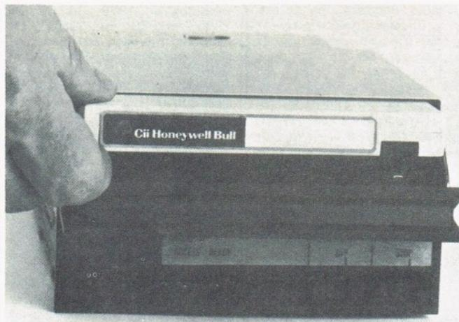
de tener un disco duro inamovible y un segundo disco colocado en un cartucho de 10 cm. de ancho que puede ser retirado y reemplazado. La capacidad de almacenamiento será por lo tanto infinita y solución así la salvaguarda masiva de los datos. La carga frontal del cartucho permitirá sustituir en numerosos casos las unidades actuales de discos de 5 1/4" y en un mismo volumen tener una capacidad de almacenamiento 10 veces superior. Además se anuncia por un precio del orden de las 200.000 Pts.
