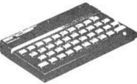
MICROPROCESADOR Z80A ■ 8 COLORES ■ 2 INTENSIDADES ■ SONIDO POR ALTA VOZ INTERNO ■ 40 TECLAS MÓVILES CON AUTO-REPETICIÓN Y SONIDO ■ MAYÚSCULAS, MINÚSCULAS, CARACTERES GRÁFICOS, INVERSOS Y DEFINIBLES ■ CÓDIGO ASCII ■ PANTALLA DE 24x32 CARACTERES ■ GRÁFICOS DE ALTA RESOLUCIÓN (256x192 PUNTOS) ■ BASIC SINCLAIR AMPLIADO EN 16K ROM ■ ALMACENAMIENTO DE DATOS Y PROGRAMAS EN CASSETTE (1.500 BAUDIOS) ■ CONECTOR DE EXPANSIONES.
