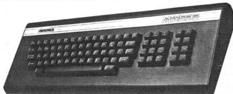
gráficos en alta resolución, 3 canales de sonido, interface centronics, pantalla de 24 líneas de 40 caracteres. También tiene conexión para cartuchos de hasta 72 K ROM. En Opción se puede añadir una tarjeta para obtener 80 columnas, doble interface RS232 y discos de 51/4", 8" y winchester utilizando CP/M. Parece un equipo atractivo pero habrá que ver cuantas pesetas nos costará.
