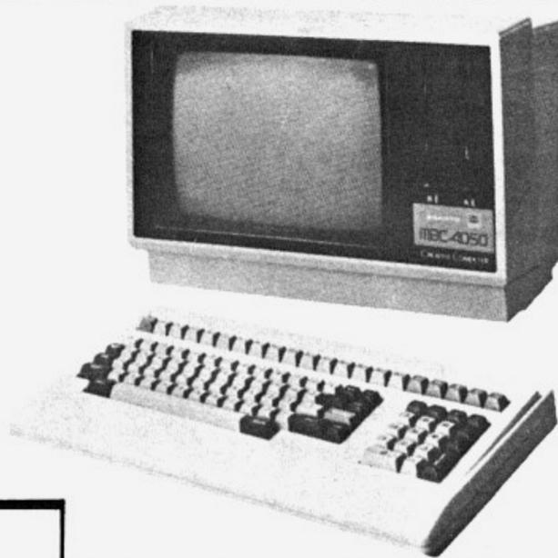
*El procesador del aparato es un 8088 que permite al MBC 4050 funcionar bajo CP/M 86.*
