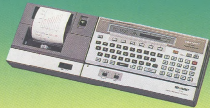
3 PC-1500 CON IMPRESORA/PLOTTER 4 COLORES Interactivo. 16 KB ROM y hasta 11,5 KB RAM. Interfaz serie/paralelo. Visor gráfico. Impresora/plotter gráfica 4 colores. Telecomunicación.
