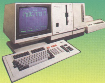
8 HAYAC-2902 CON GRAN EXPANSIÓN DE MEMORIA Une a las características del Hayac-2900 la amplia memoria en disco (10 a 40MB) para almacenar datos y acceso instantáneo a los mismos.
