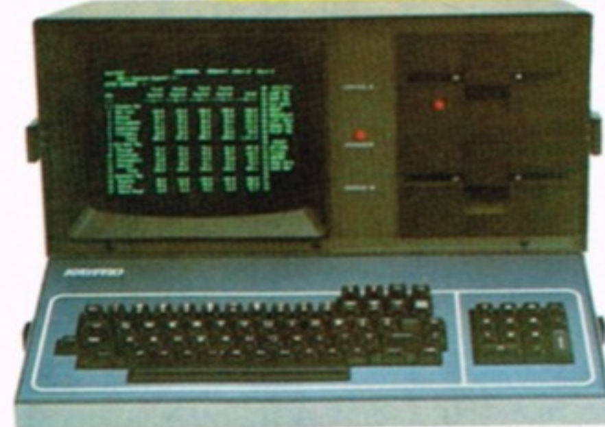
KAYPRO 10, con un disco duro, Winchester de 10 Mbytes, y una unidad de disco flexible de 400 kbytes, gráficos y pantalla pancromática.
