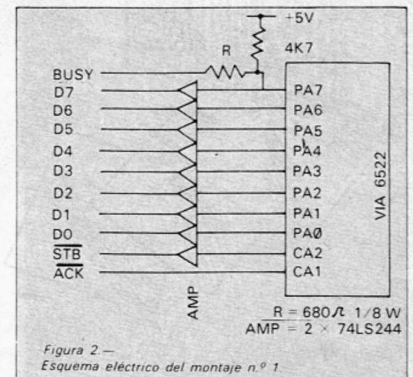
Figura 2.— Esquema eléctrico del montaje n.º 1.
