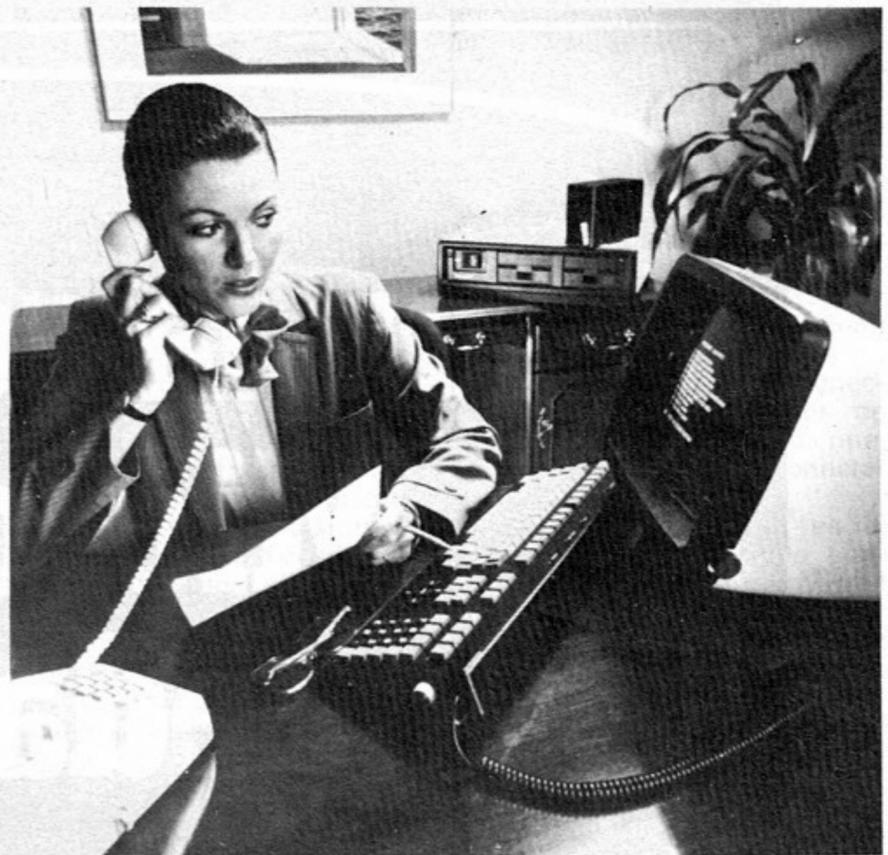
nal 3278). Puede ser explotado bajo CP/M 86 y MS-DOS. En su configuración básica, consta de: 512 Ko, dos diskettes de 650 Ko y un puesto de trabajo con pantalla asincrónica. Las primeras entregas están previstas para Abril de 1984.
