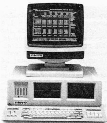
30, 40 ó 60 MB formateado. Sistemas operativos MS-DOS, XENIX, CONCURRENT CP/M86. Conexión de periféricos serie y paralelo tipo Centronix ó DURANGO con posibilidad de hasta 12 puestos de trabajo.
