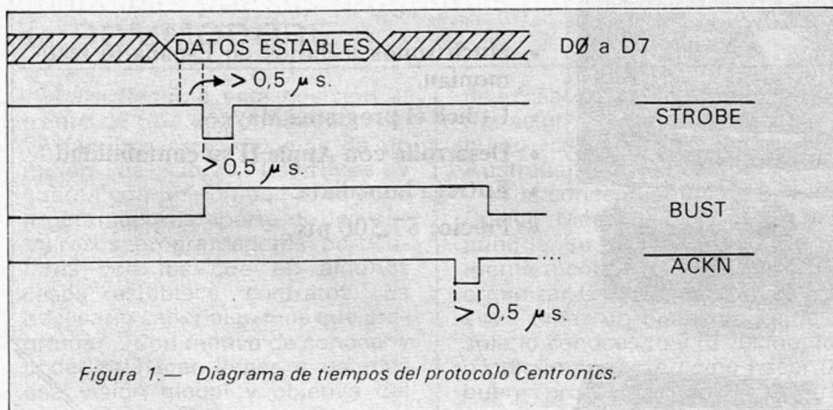
Figura 1.— Diagrama de tiempos del protocolo Centronics.
