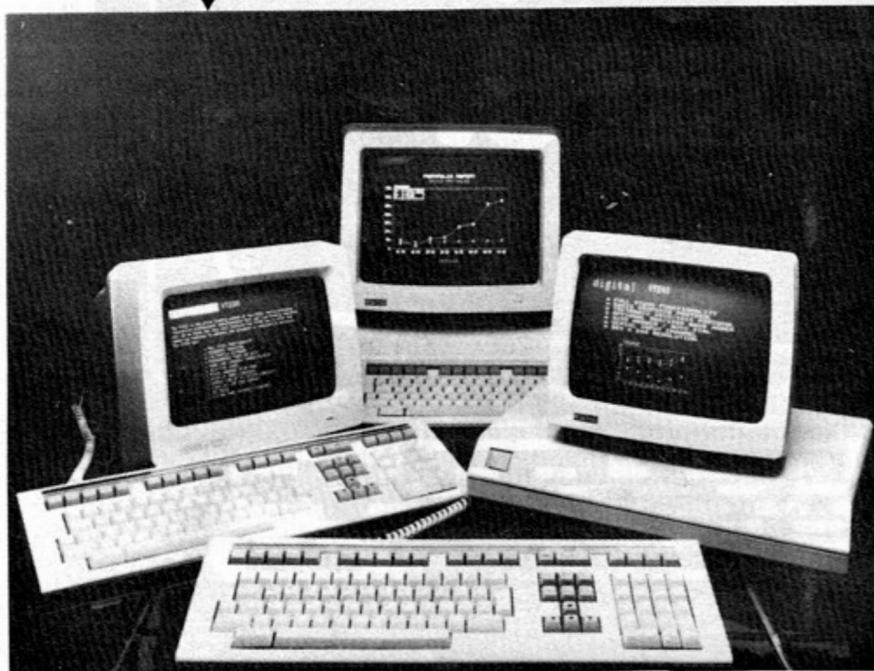
El terminal VT220 es una unidad monocromática de dos piezas que consta de un teclado ergonómicamente diseñado y un monitor anti-reflexivo de 12 pulgadas. El monitor, compacto y en forma de cuña, está disponible con pantalla ámbar, verde o blanca, y contiene toda la circuitería lógica.
