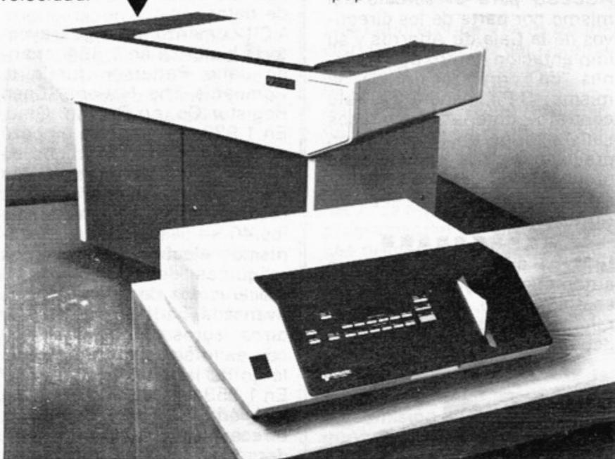
ACRIS, que explora hasta 200 líneas por segundo, es capaz de interpretar hasta tres tarjetas por minuto, ofreciendo una salida cuya resolución es de 200 x 200 barridos por pulgada. Los diseños pueden ampliarse o reducirse. Mediante la utilización de un plotter adecuado, puede producir dibujos en tamaños que varían desde A 4 hasta A 0.
