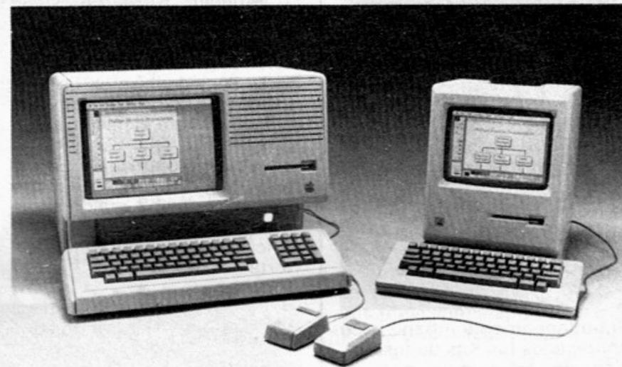
su elevado precio de venta. La nueva gama Apple 32 provista de microprocesadores de 32 bits, disquetes de 3,5 pulgadas y facilidad de utilización, trata de ser la tercera generación que deberá hacer de un IBM PC un ordenador obsoleto.
