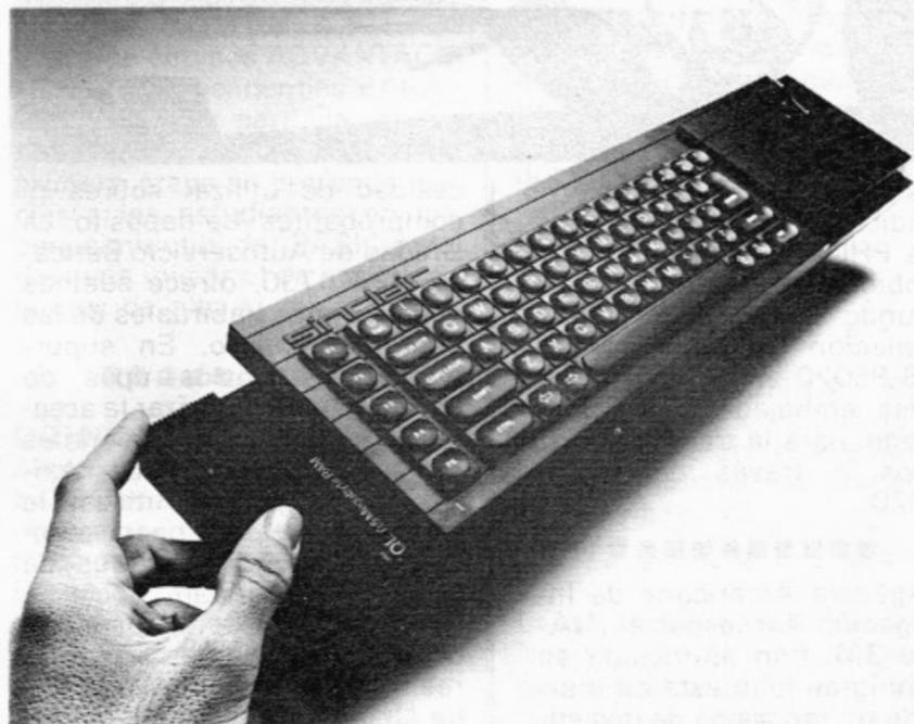
estructura interna de 32 bits y bus de datos de 8 bits— funcionando a 7'5 MHz. Posee 128 Ko de RAM (32K utilizados para la pantalla) ampliables externamente hasta 640K. Sus 32 Ko de ROM contienen el sistema operativo QDOS y el Basic-Mediante un bus a tal efecto, pueden conectarse cartuchos ROM de 64K.
