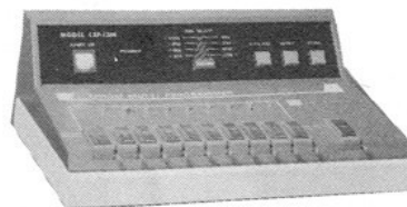
Multiprogramador de EPRONS: LEP. 1200 para grabar 10 EPRONS a la vez para las 2716, 2732, 2732A, 2764A, 2516, 2532, 2564, 68766, 27128, o cualquier otra que sea compatible.
