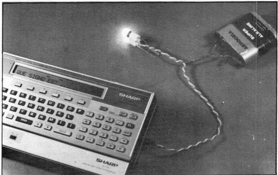
Hay que empezar cortando el cable en tres trozos (longitudes al gusto del consumidor), pelando un poco sus extremos para hacer las conexiones.
