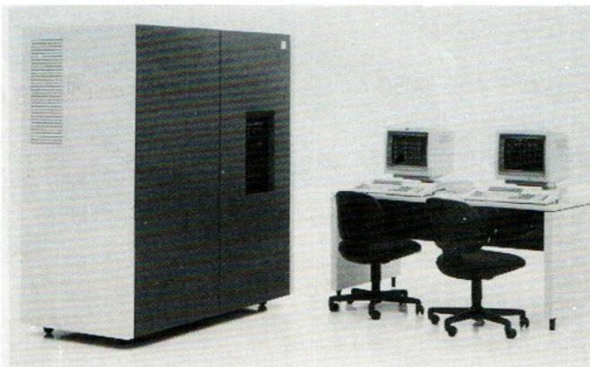
El **IBM 4381-3** es un procesador dual con dos procesadores de instrucciones, similares al del 4381-2, cada uno con su antememoria de 32K. Se ofrece con 8, 16, 24 ó 32 MB y utiliza también el chip IBM de 256 Kbits de capacidad. Su tamaño físico es idéntico al del resto de los 4381.
